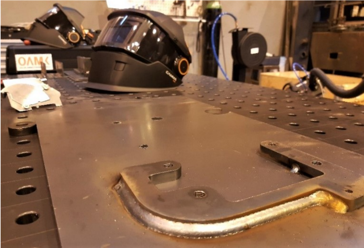
KUVA 2. Hitsauksen tasalaatuisuus on robotisoidun hitsauksen suurimpia hyötyjä (kuva: Vesa Rahkolin)
