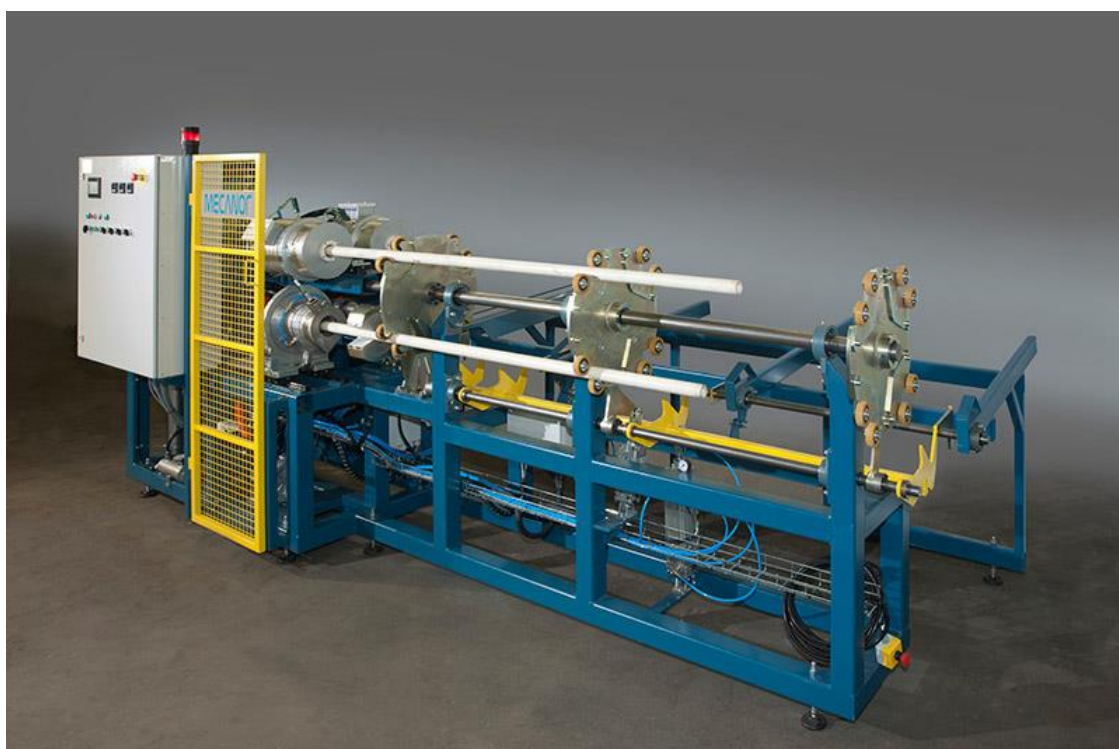
KUVA 1. Mecabell muhvauskone (Extron-Mecanor Oy n.d.)
