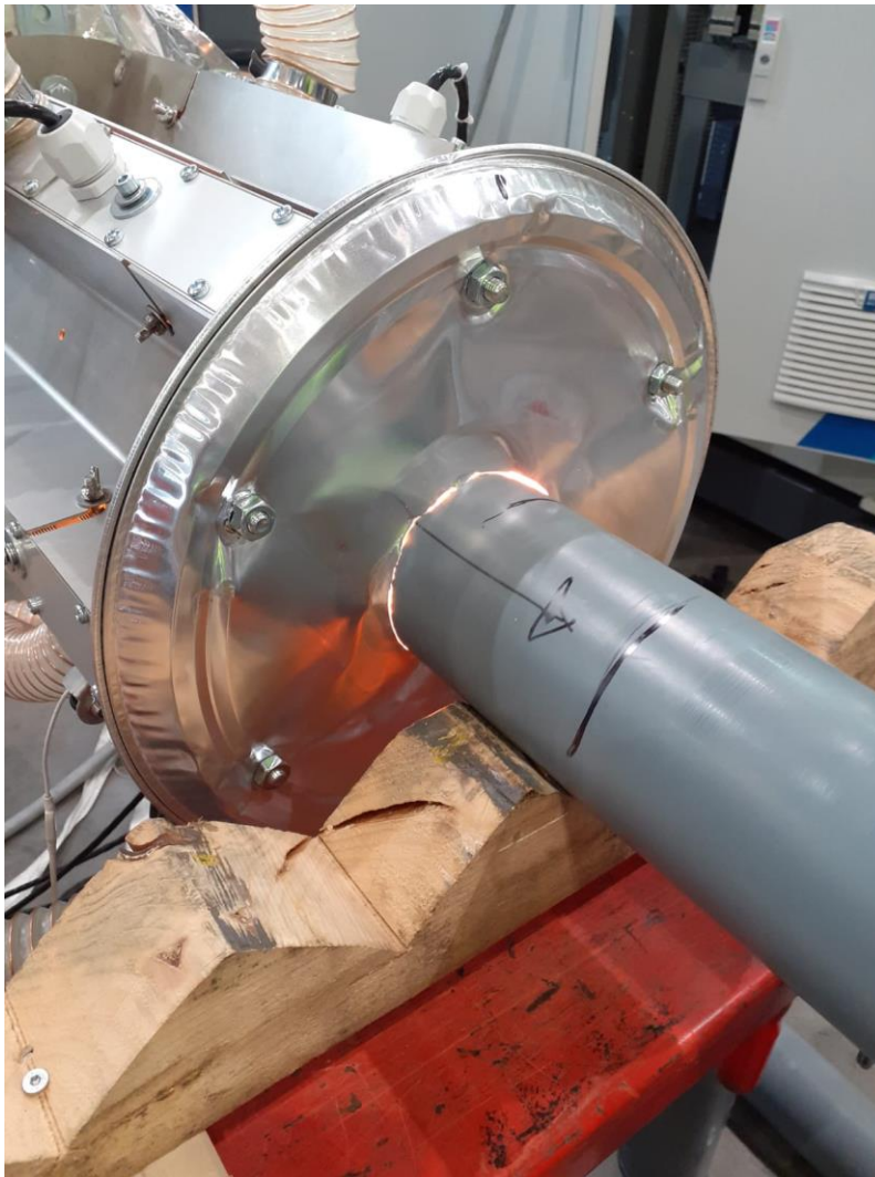
KUVA 20. Infrapunauunin päiden sulkeminen
