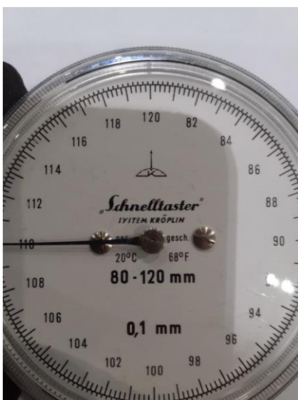
KUVA 15. Schnelltaster sisämittalaitteen mittausalue ja -tarkkuus
