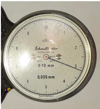
KUVA 17. Schnelltaster ulkomittalaitteen mittausalue ja -tarkkuus
