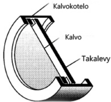
KUVIO 7. Kondensaattorimikrofonin rakenne (Shure 2007, 5.)
