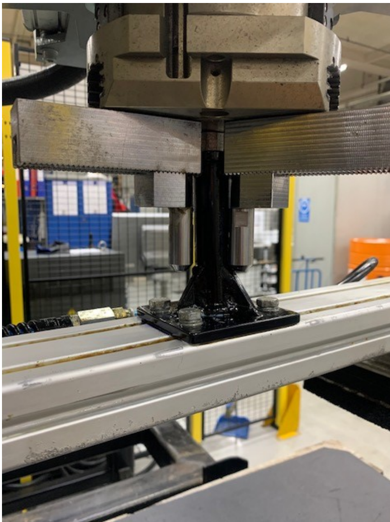
Kuva 17. Välipahvitarttujan kiinnitin ja robotin leuat.
