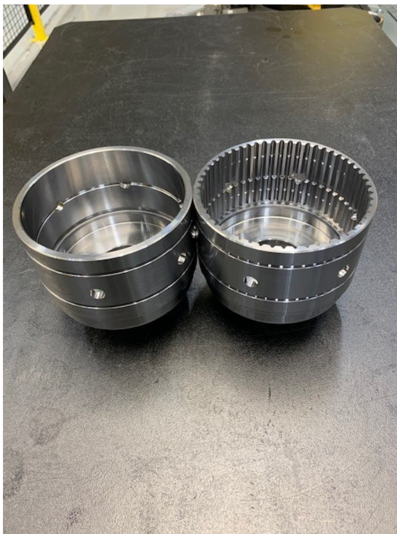
Kuva 8. Kytkinkotelon sorvattu aihio ja pistokoneistettu uritus
