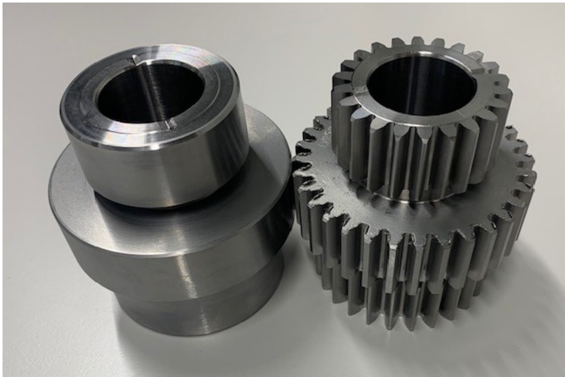
Kuva 11. Kolmoispyörän sorvattu aihio ja pistokoneistettu hammastus.
