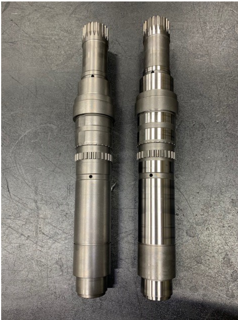
Kuva 14. Lämpökäsitelty akseli ja hiottu akseli.
