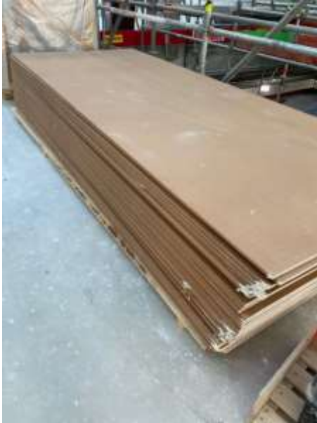
Kuva 18. Kipsilevy siirroista aiheutuneet vauriot
