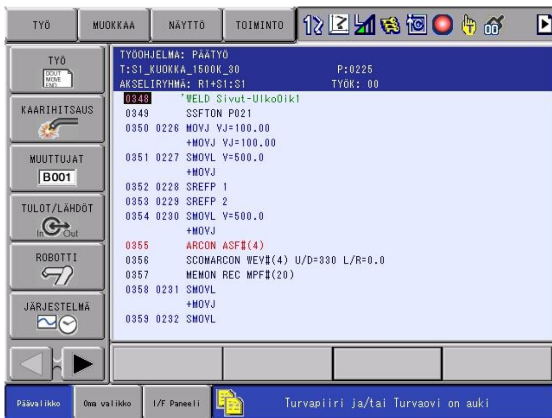
Kuva 13. Hitsauksen aloitus ohjelmakoodissa.
