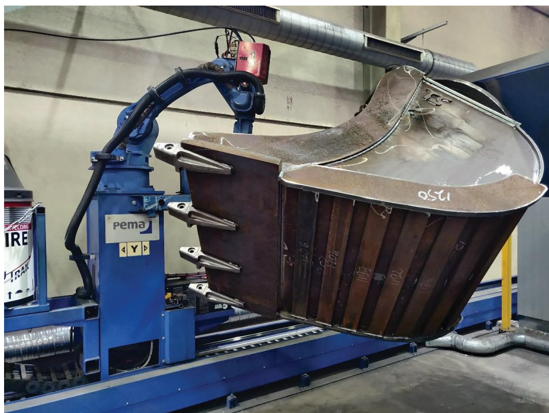
Kuva 15. Kynsikuokka 1500 NTP30 hitsausohjelman suoritus.
