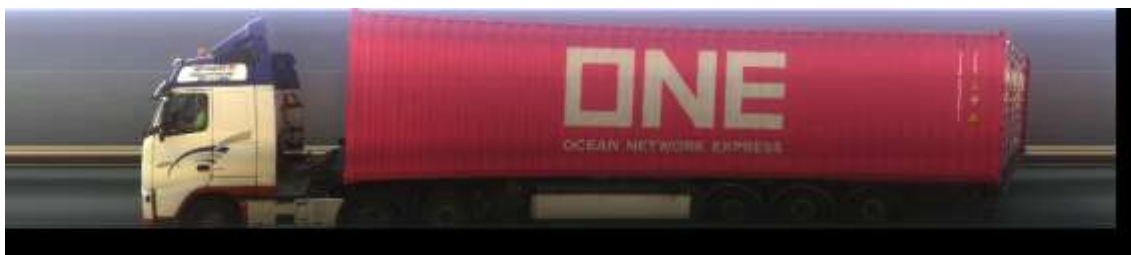
Kuva 12. Esimerkki 1, viivakamerateknikalla tallennetusta kuvasta. Vääristymä johtuu ajolinjan kohtisuoruspoikkeamasta ja nopeuden vaihtelusta suhteessa kameraan (Helsingin Satama Oy 2017).
