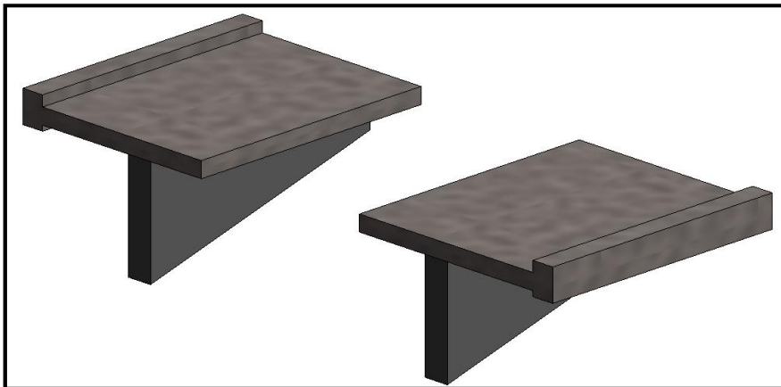
Kuva 14. Maatuen reunaulokkeet jatkuvat siipimuurin yli (Tyyppi 2).
