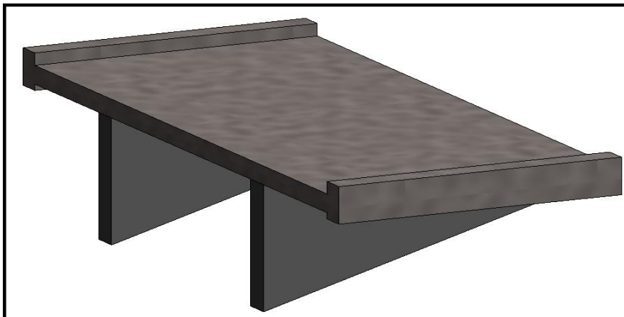
Kuva 15. Maatuella yhtenäinen kansirakenne (Tyyppi 3).
