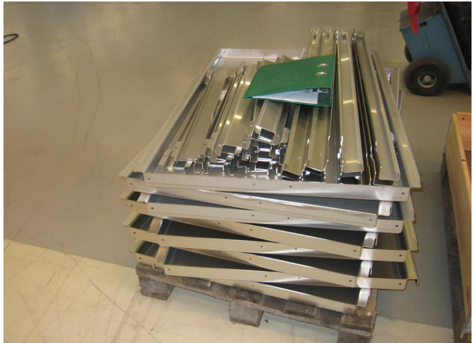
Kuva 24. Tuotannossa valmistetut vetotasojen levyosat.
