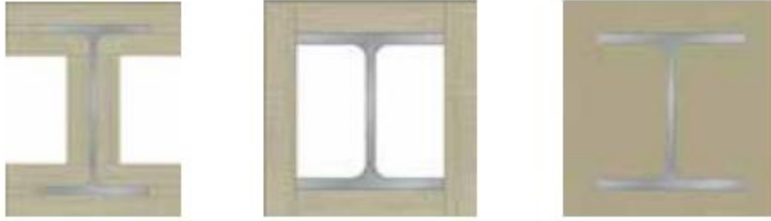
Kuva 4. Profiilimyötäinen asennus, kotelointi ja ruiskutettava suojaus (Paroc palosuojaus, [viitattu 12.10.2020]).
