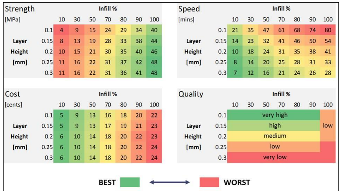
Kuva 26. Diagrammilla voidaan vertailla kerrospaksuuksien ja täyttöasteen suhdetta. [44.]
