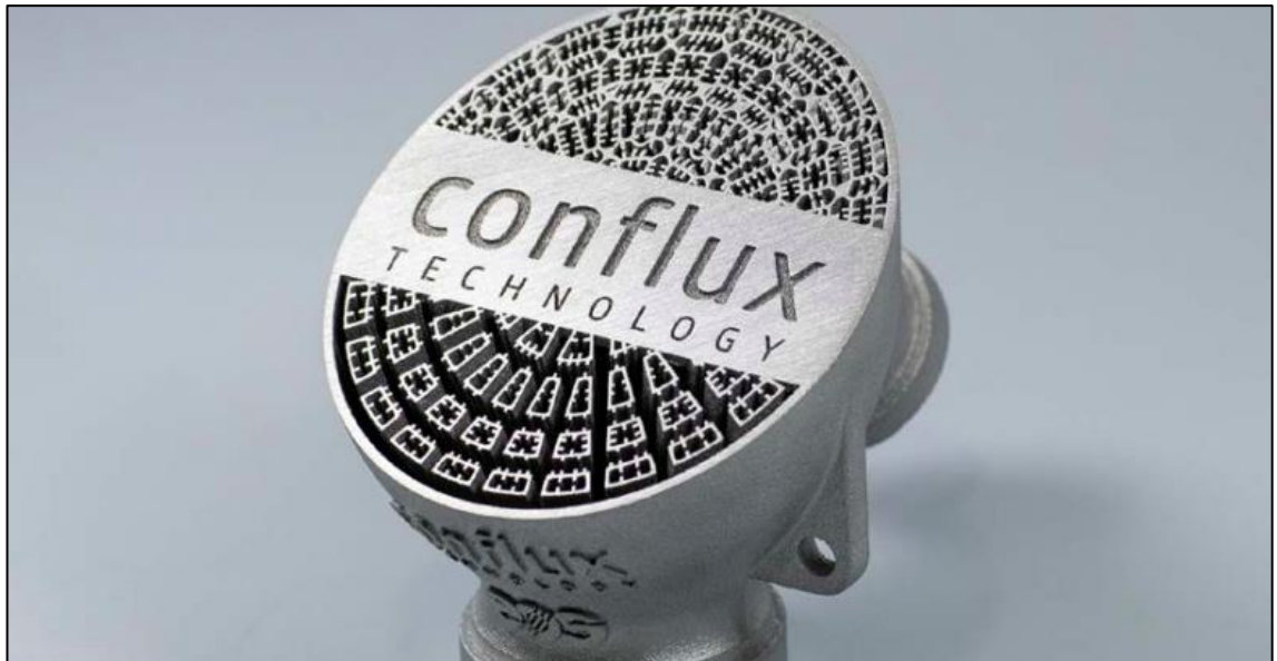
Kuva 8. Metallijauheesta tulostettu lämmönsiirrin. [36.]
