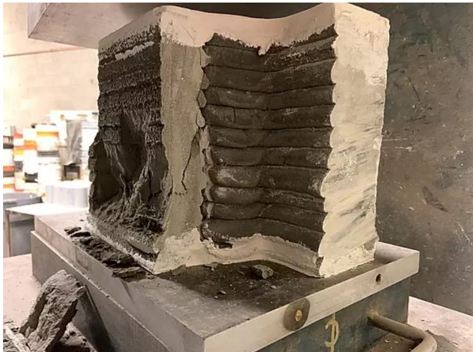
Kuva 25. 3D-tulostettu seinän osa puristuslujuus testissä. [30.]
