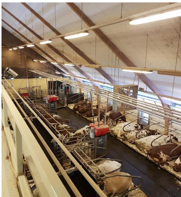
Kuvio 3. Näkymä kävelyparvelta alas navettaan. Ruokintapöydät sijaitsevat kävelysillan alapuolella ja robotti toisessa päädyssä.
