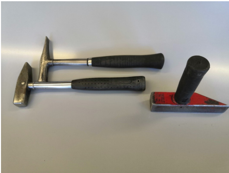
Kuva 17. Vasemmalla peltisepänavasaroita ja oikealla kosakka.
