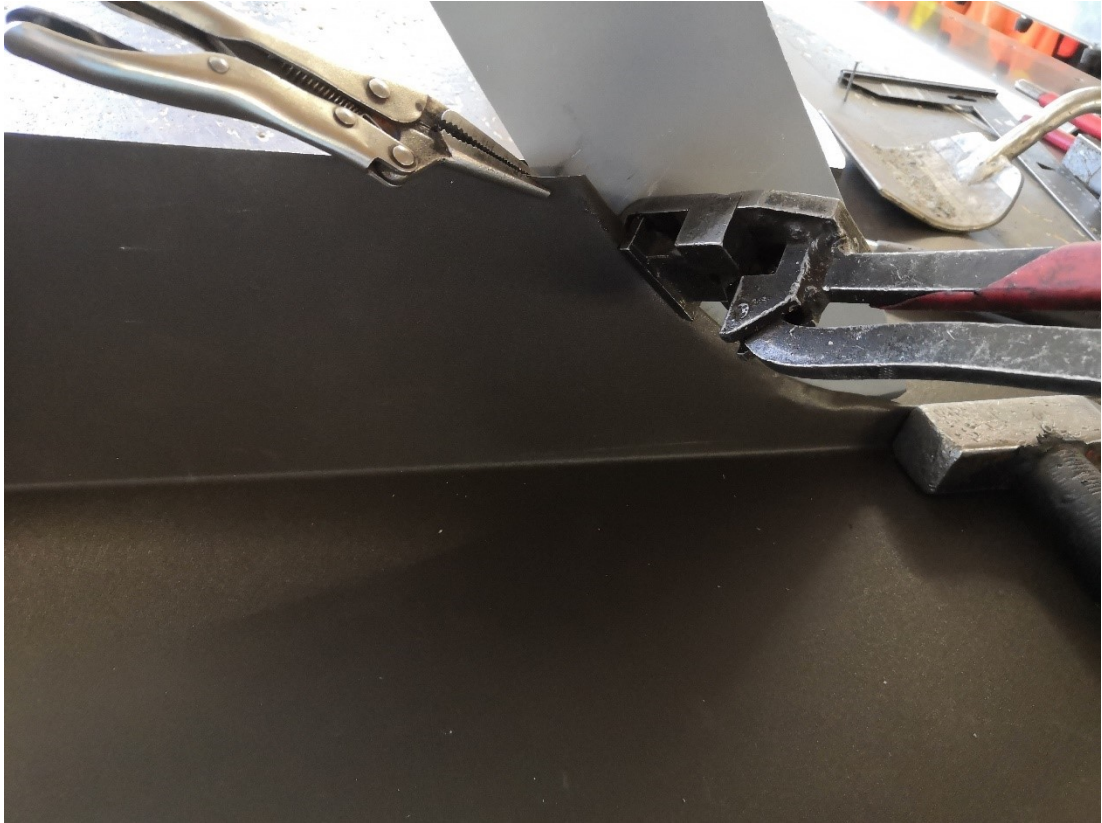
Kuva 162. Tuplaan taittaminen onnistuu parhaiten tuplasaumapihtien avulla.
