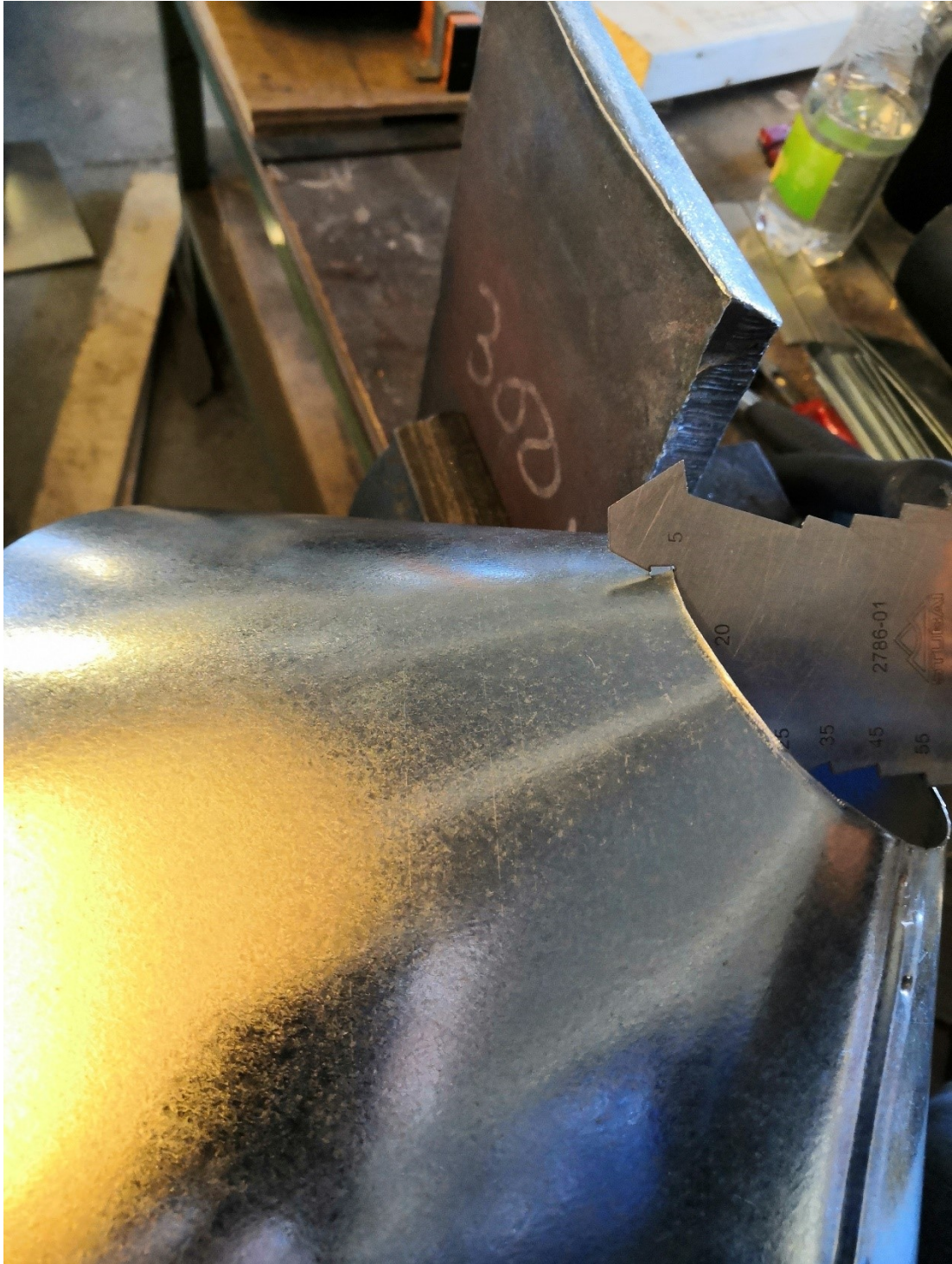
Kuva 213. Kartion alaosaan merkitään piirtotyökalun avulla 5 mm viiva, jonka mukaan pieni sauma muotoillaan vasaran terävällä päällä. Peltiä venytetään vasaroinnin yhteydessä.
