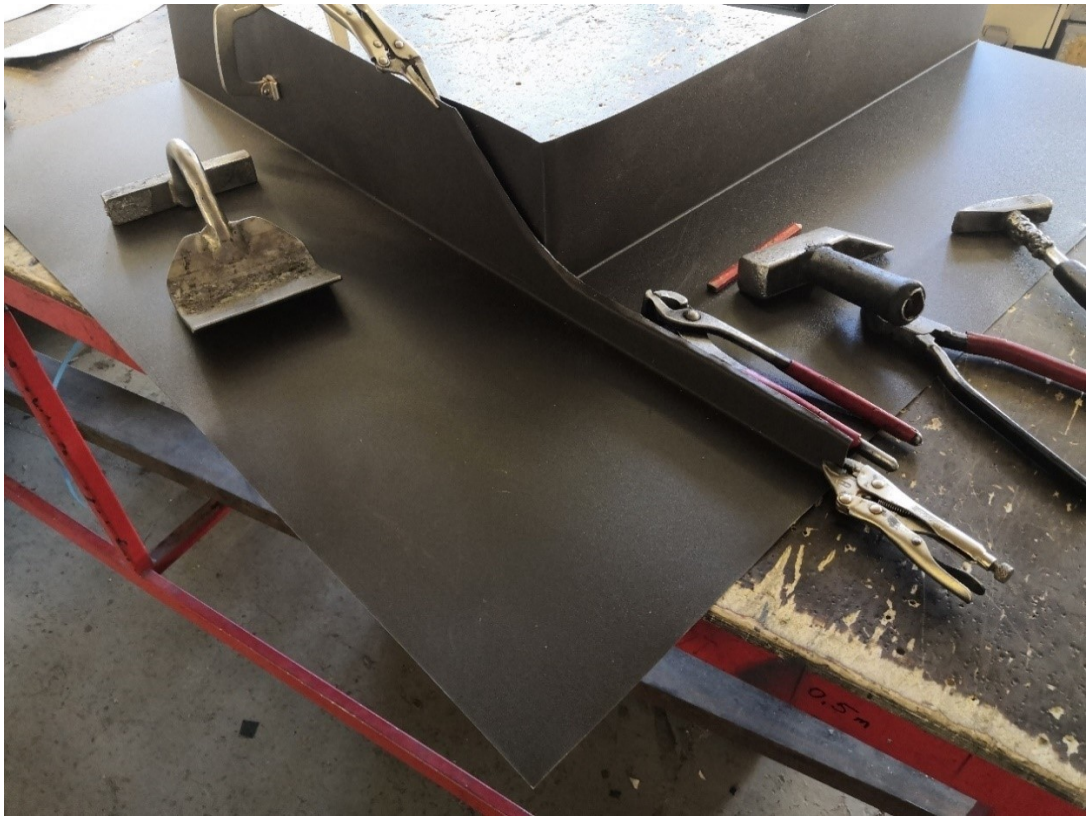
Kuva 160. Saumaus aloitetaan saumaamalla palat ensiksi englaan. Lukkopihdit pitävät saumattavat kappaleet oikeassa kohdassa.
