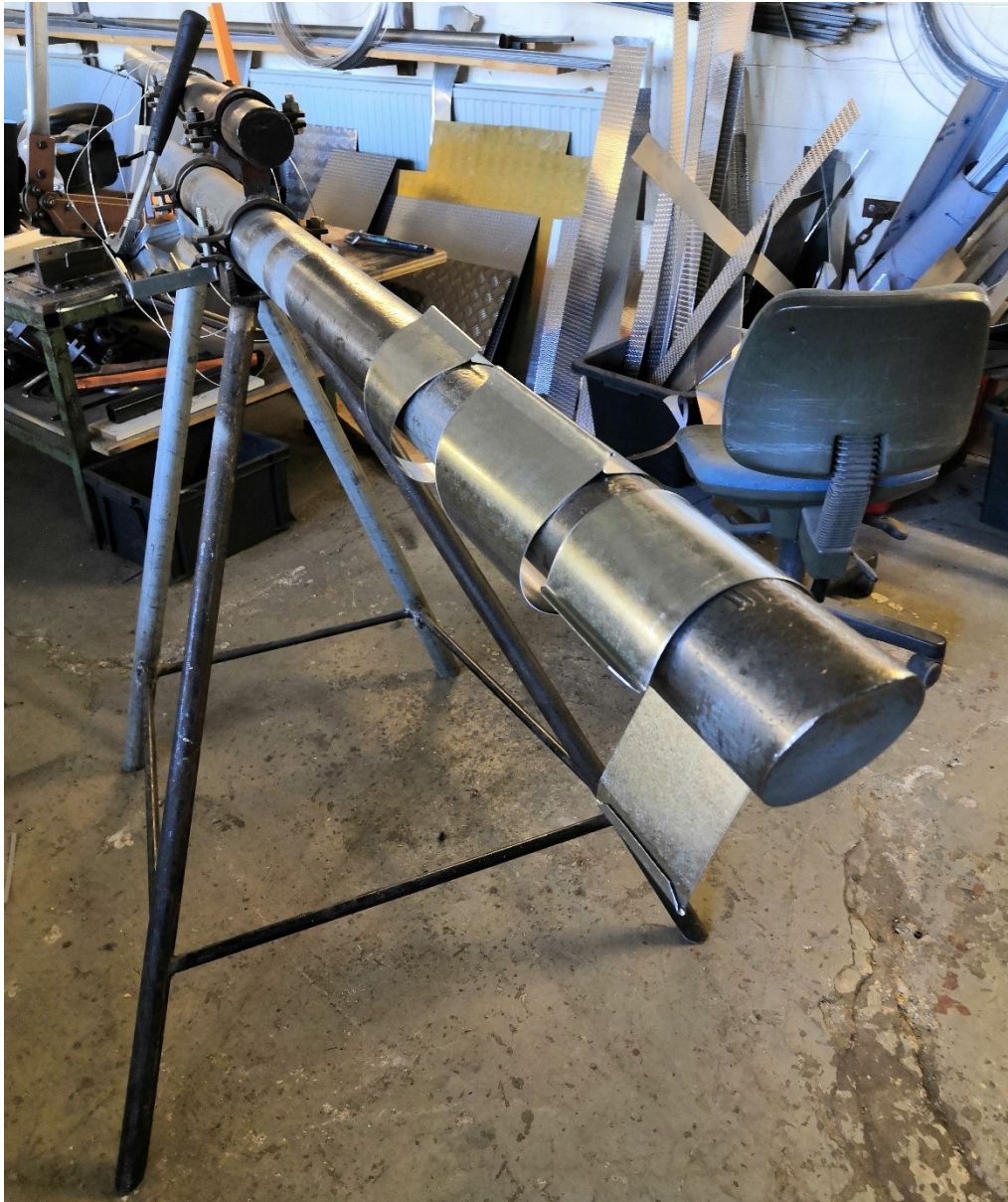
Kuva 204. Osien pyöristys. Pienemmät osat pyöristyvät rautaa vasten, eikä niitä ole välttämätöntä käyttää mankelissa.
