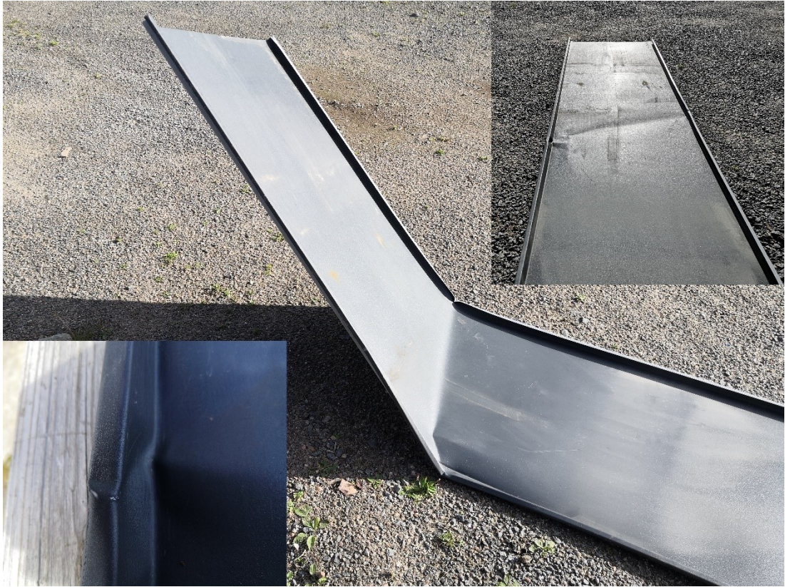
Kuva 113. Rivi on taittunut noston aikana. Pikkukuva vasemmalla, sauma on kärsinyt ja siihen on syntynyt halkeama suoristamisen yhteydessä. Pikkukuva oikealla, vaikka pelti saadaan suoristettua, jää riviin lommo, joka pistää silmään.
