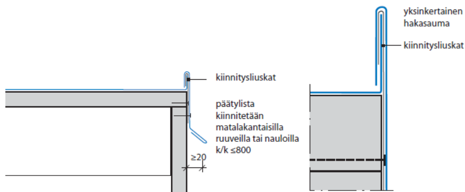
Kuva 226. Tavanomainen päätyräystäsdetalji (RT 85-11158 2014, 18).
