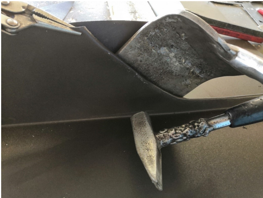
Kuva 163. Tuplasauma lyödään kiinni siten että lapion kärki on työnnettynä sauman taakse taitoksen sisään.
