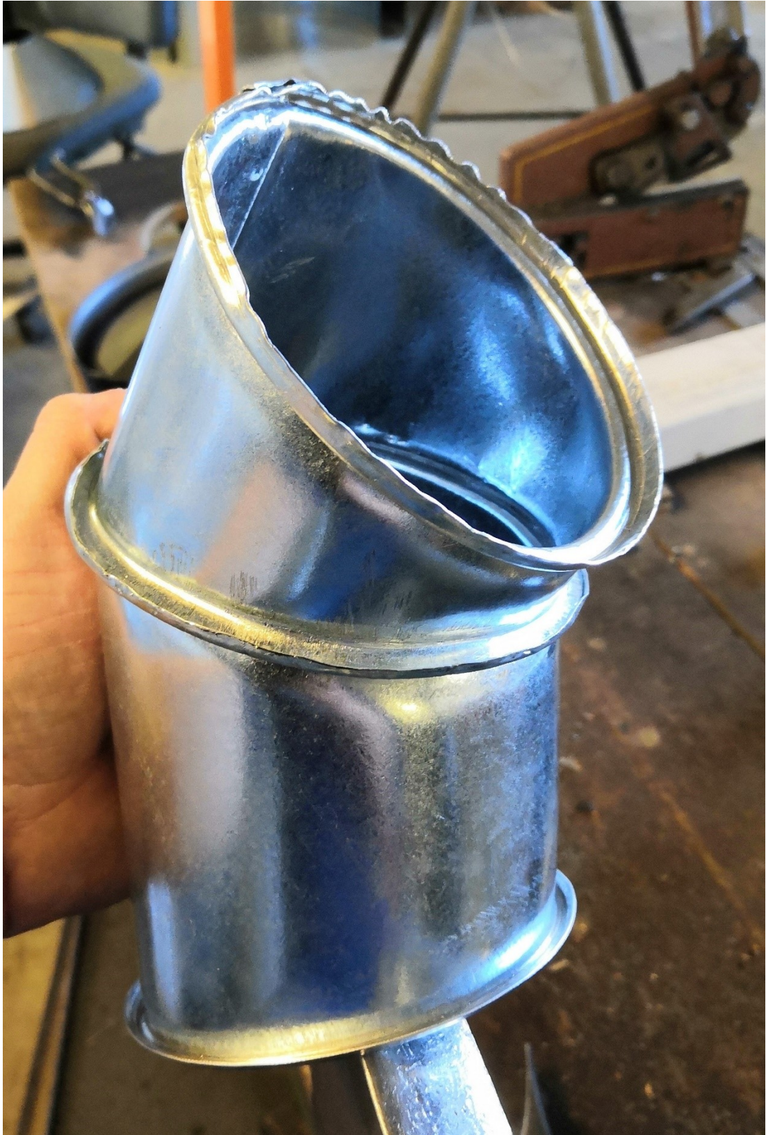
Kuva 208. Osien yhteensovittaminen. Ulosheittäjän ensimmäinen sauma on valmis saumattavaksi.
