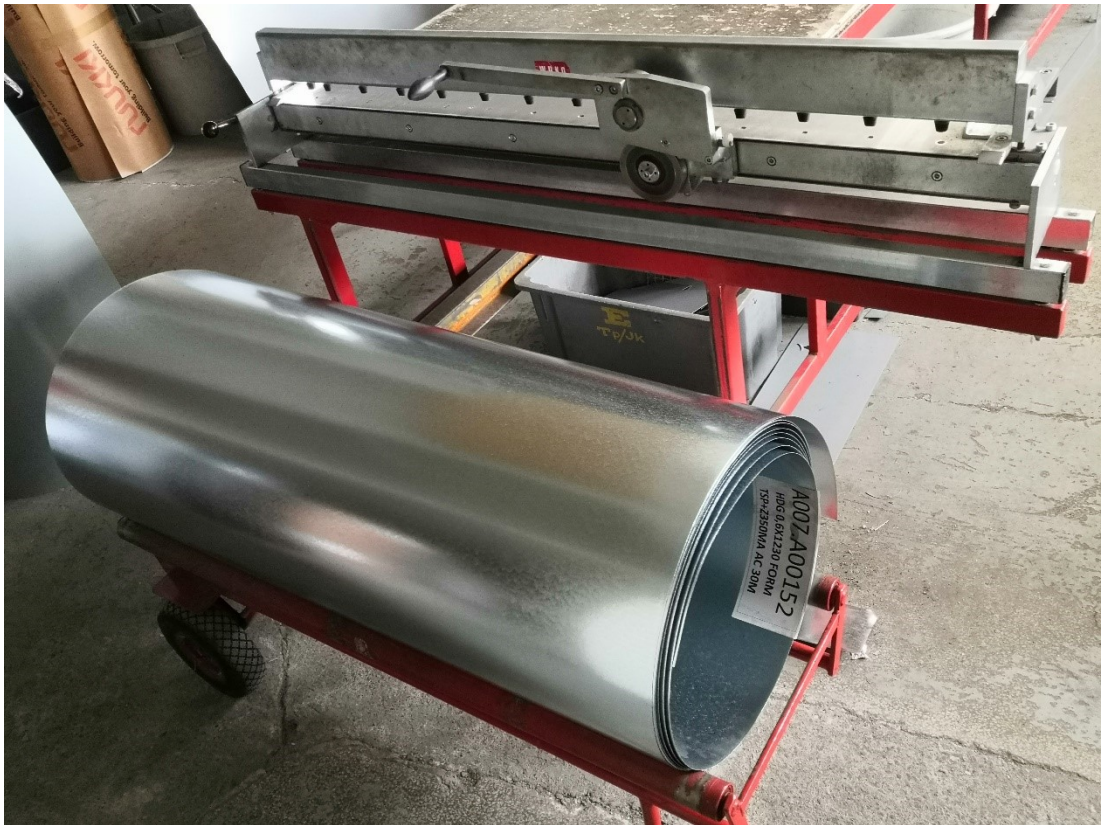
Kuva 71. Leikkuri työpöydän päässä, jolla voi leikata rullalla olevaa peltiä.
