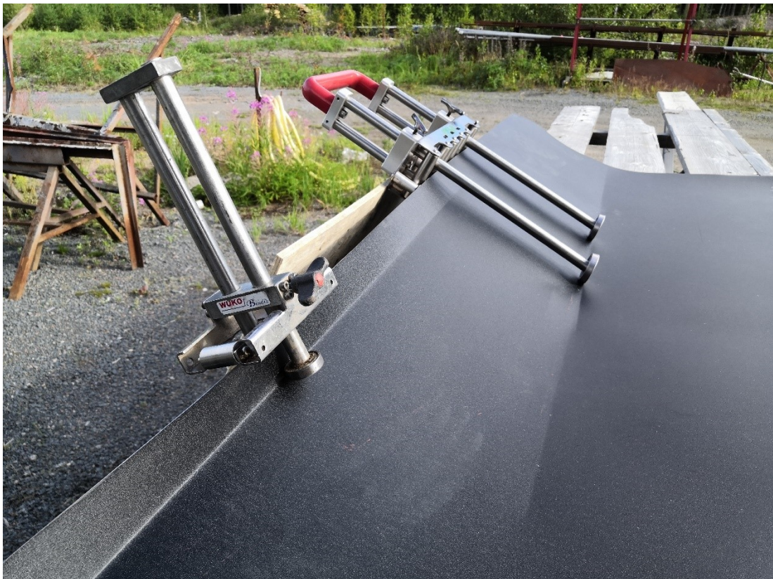
Kuva 45. Taivuttimilla voidaan kantata käsin esimerkiksi kuvan jiiripeltiä. Lyhyet kantit valmistuvat helpommin pienikokoisemmalla taivuttimella.
