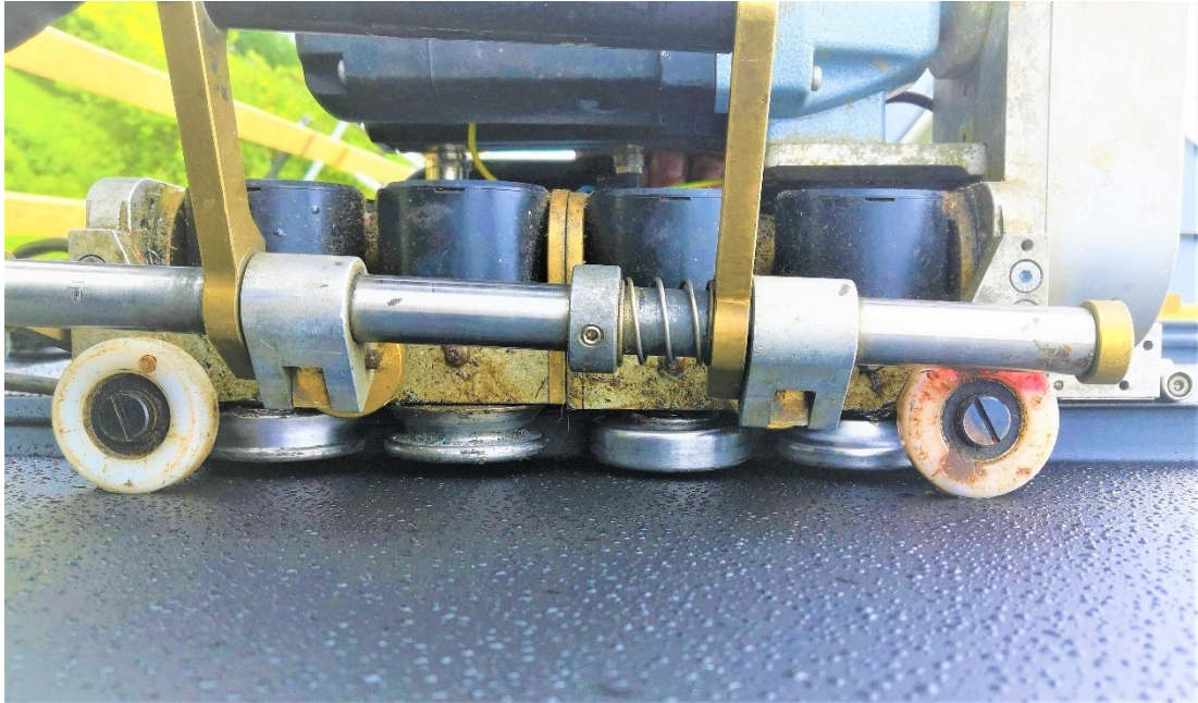
Kuva 81. Vasemmalla koneen takana koneensulkemaa saumaa, oikealla koneen edessä englasauman ensimmäinen vaihe suljettuna englaraudalla. Koneen etenemissuunta kuvassa vasemmalta oikealle.
