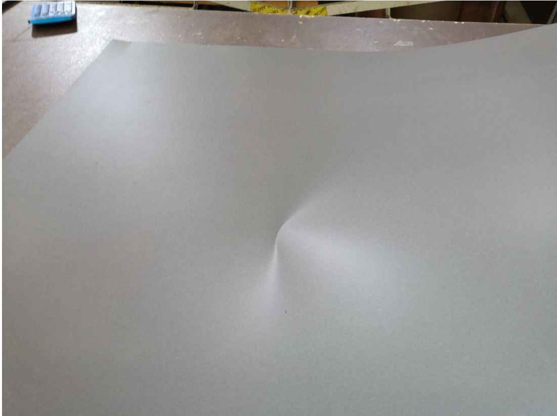
Kuva 111. Peltiarkki on lommahtanut. Tällainen lommo syntyy, kun isoa arkkia nostetaan yhdestä kulmasta varomattomasti tasolla.
