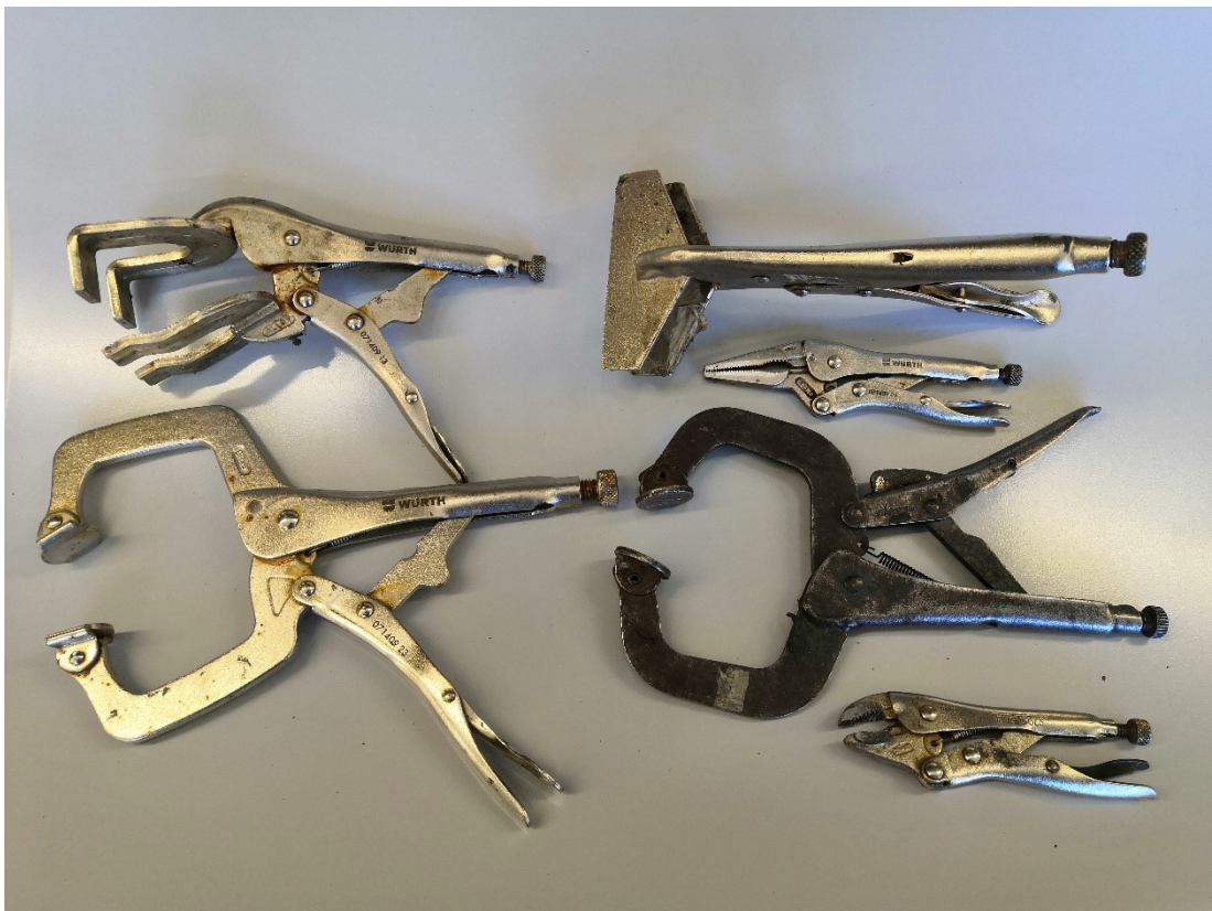
Kuva 33. Erilaisia lukkopihtejä. Vasemmalla ylhäällä hitsarin pihtit. Keskellä C-lukkopihtejä. Oikealla toisiksi ylinä pitkäkärkiset lukkopihtit, joita käytetään paljon palojen saumauksessa. Pitkäkärkiset pihtit pitävät peltikerrokset paikoillaan saumauksen ajan ja vievät vähän tilaa.
