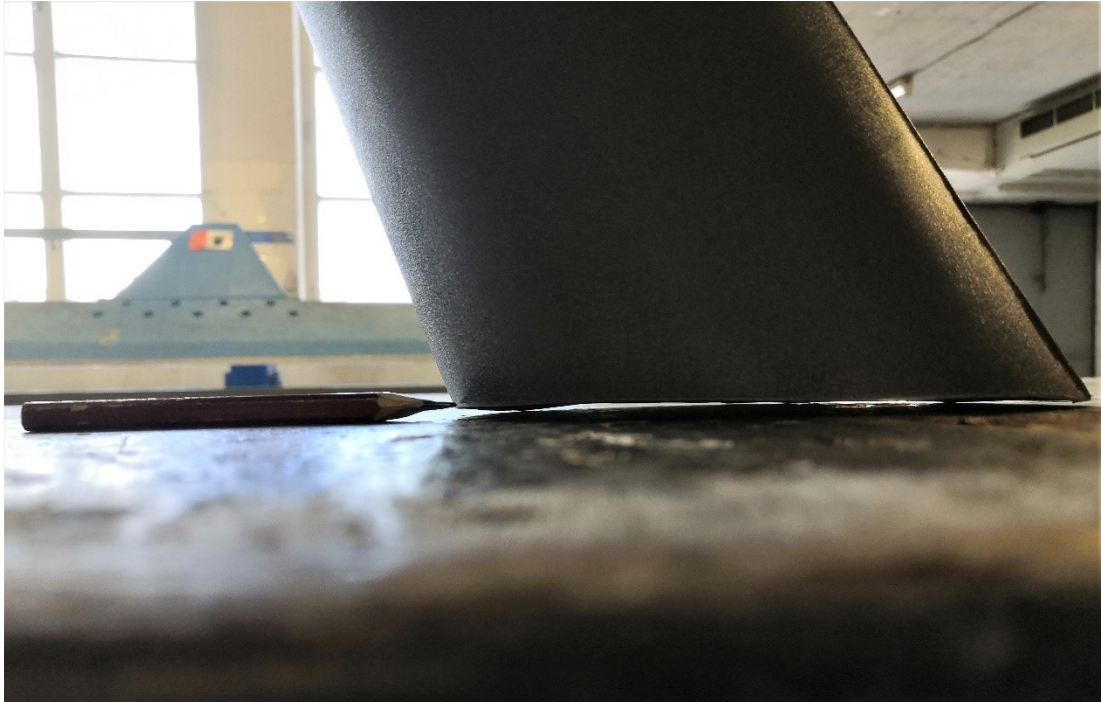
Kuva 304. Kartion alareuna ei ole täysin suora. Linja on kyllin lähellä, jotta kynällä voidaan piirtää tarkka leikkauslinja pöytää vasten. Kartion tulee olla paikoillaan viivaa piirrettäessä.
