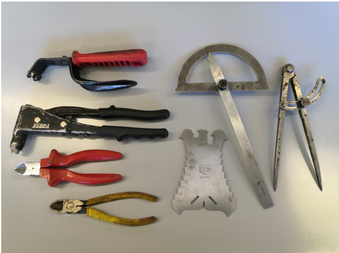
Kuva 51. Vasemmalta ylhäältä, jäysteenpoistaja peltilevyille, vetoniittipihdit, sivuleikkureita, piirtotyökalu, kulmamitta ja harppi.
