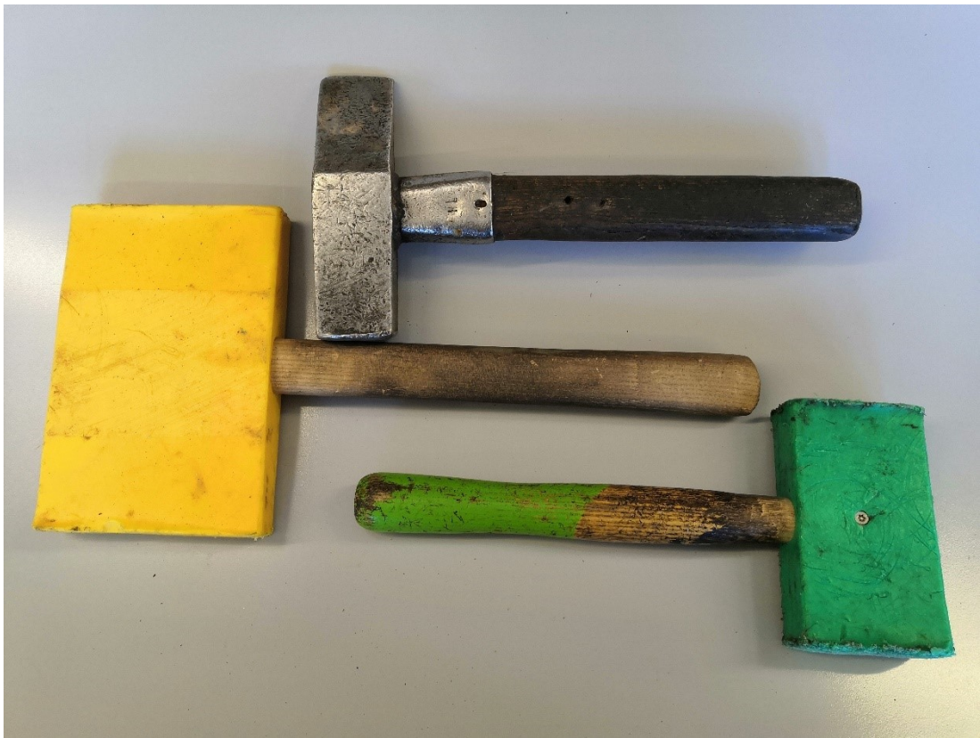
Kuva 18. Nuijia, keltainen 500 g, vihreä 300 g ja ylinnä edellisestä kuvasta poikkeava kosakka.
