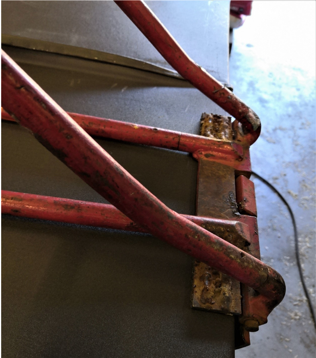
Kuva 42. Rästäsrauta käytössä. Kuvassa olevan raudan päihin on hitsattu vahvikkeeksi saumat, varsinkin kaadetun pystysauman kohdalta puristettaessa pää pyrkii taipumaan.
