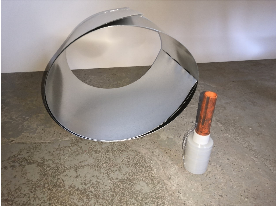
Kuva 108. Kapea 100 mm kelmu on kätevä pakkausväline peltiosille. Kuvassa myös pitkä peltiraina, joka on helpointa kuljettaa rullattuna.
