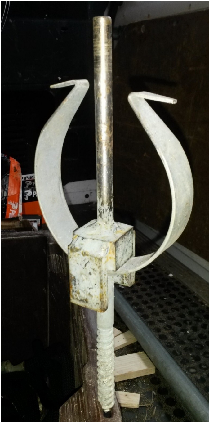
Kuva 219. Syöksytorven koukku ja apuväline kiinnittämistä varten.
