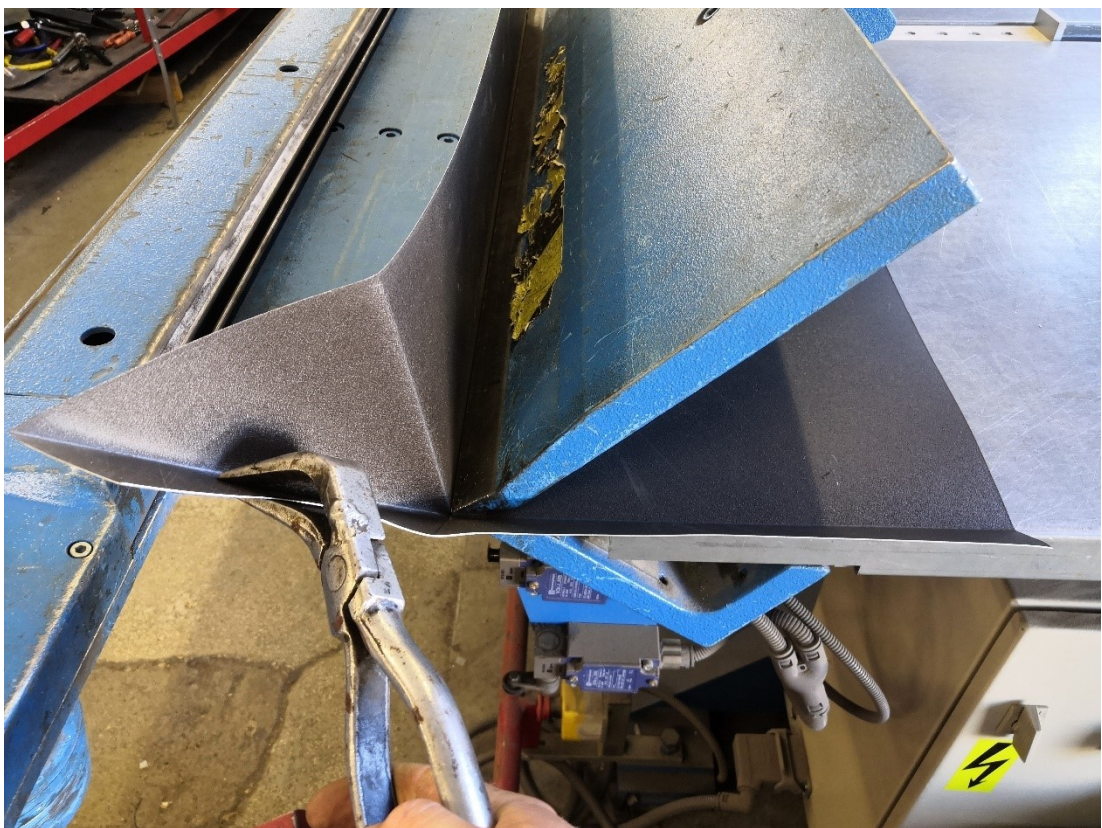
Kuva 157. Kulmaa muokataan vaiheittain kanttipihtien avulla.
