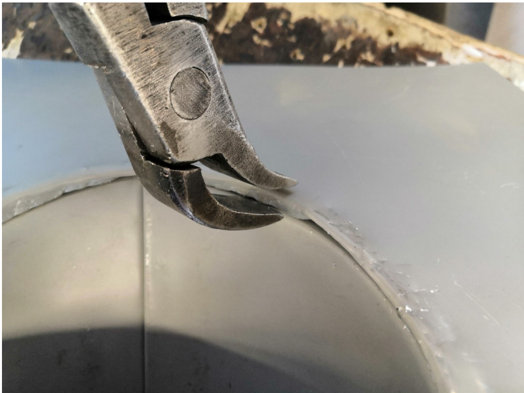
Kuva 308. Kartion saumausta pienten listapihtien avulla. Tähän tarkoitukseen soveltuvat hyvin myös siirtoleukapihdit.
