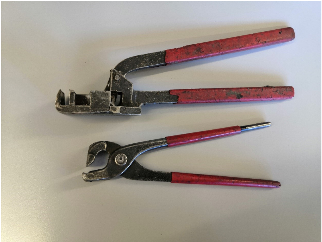
Kuva 28. Tuplasaumapihdit yllä ja purkupihdit alla.
