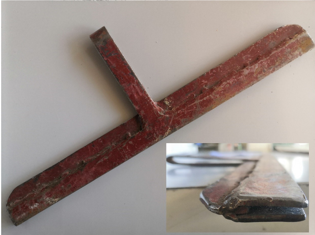
Kuva 49. Räystään taittorauta, käytetään hakasaumojen teossa. Kitasyvyys n. 23 mm.
