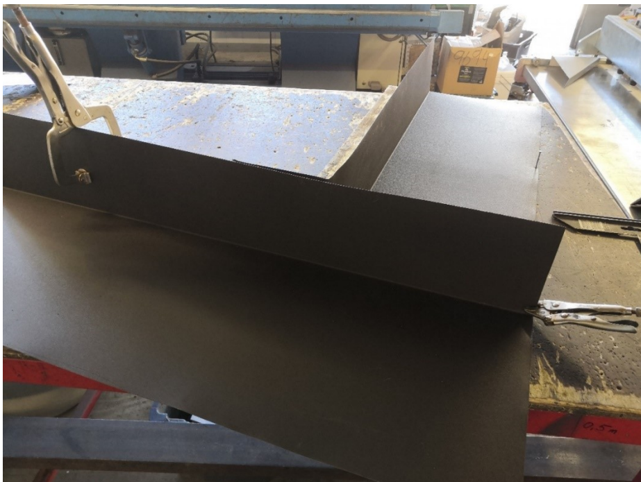
Kuva 159. Seuraava pelti kiinnitetään lukkopihdeillä paikoilleen.
