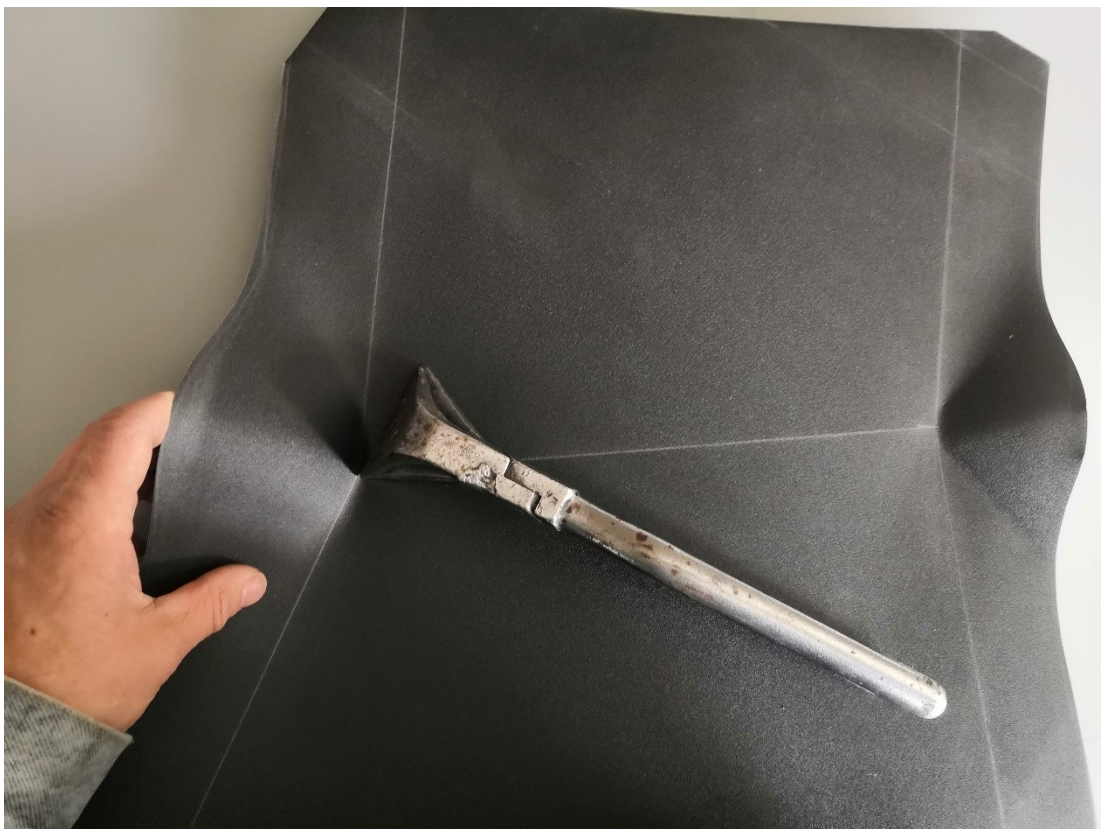
Kuva 14. Piipun sivupalan valmistuksen yhteydessä tapahtuva lommahduksen ohjaaminen.
