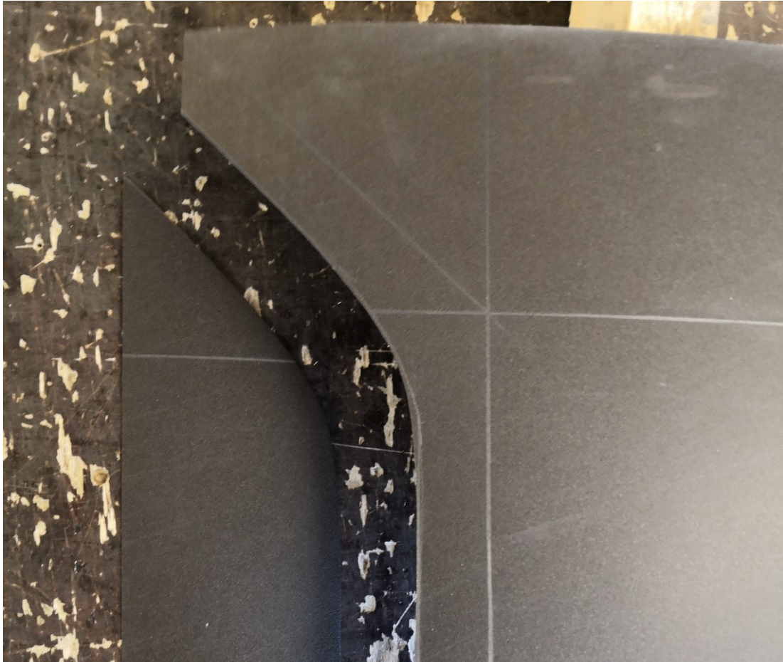
Kuva 154. Ylimääräinen pala leikataan pois. Leikkauksesta jäävää ylimääräistä peltiä voidaan hyödyntää myöhemmin saumausvaiheessa suoja-peltinä.
