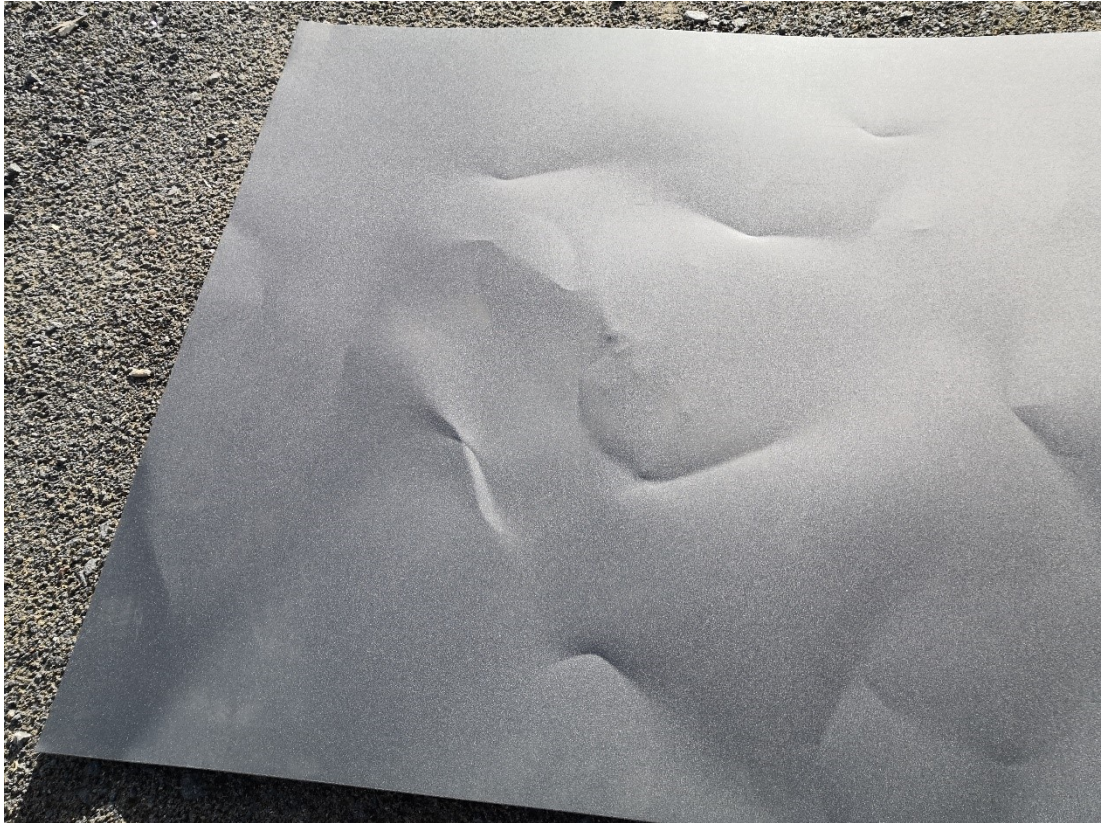
Kuva 112. Suuri peltiarkki on kauttaaltaan lommoinen, mikäli se noston aikana pääsee putoamaan.
