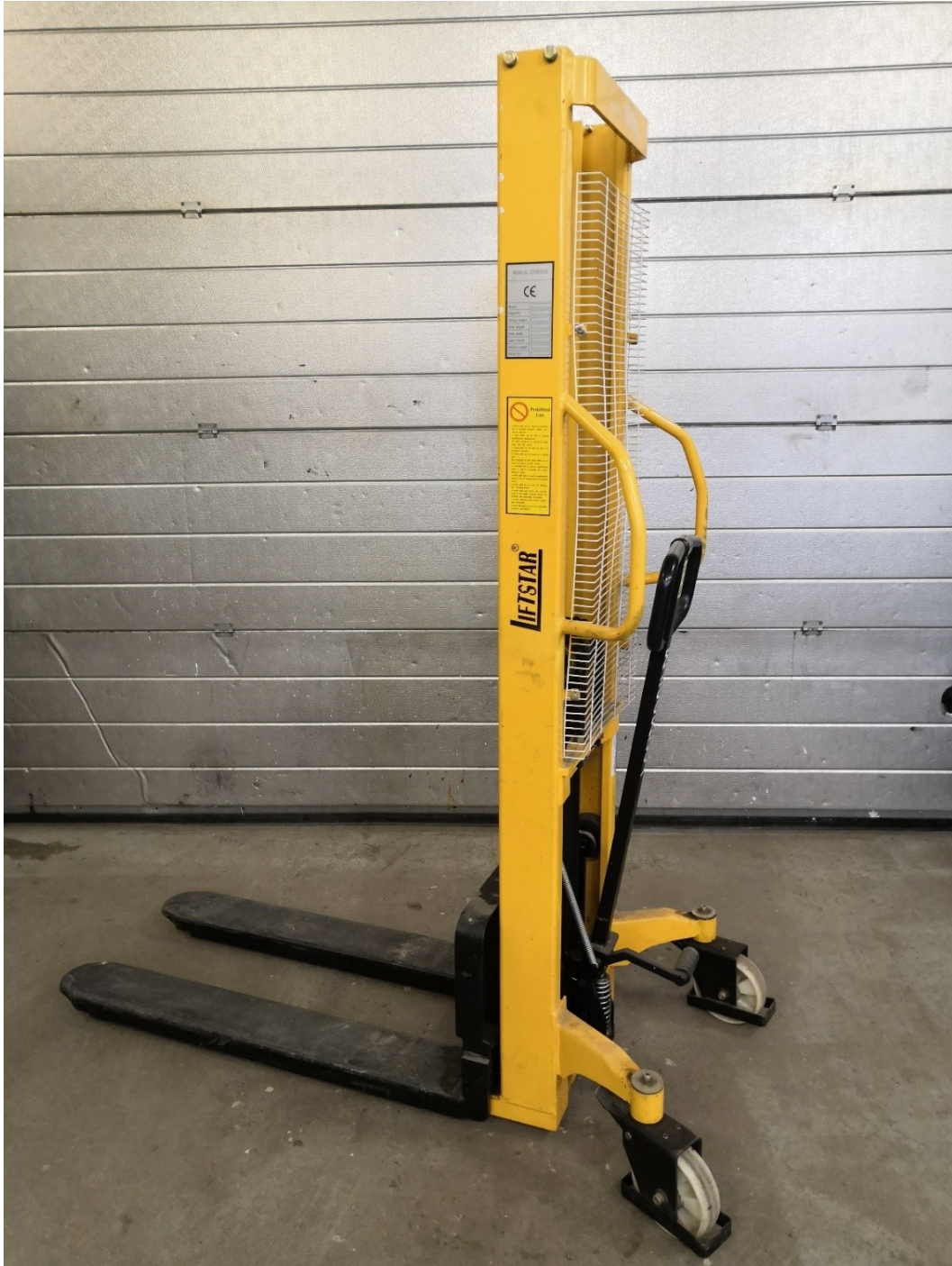
Kuva 106. Pumppukärky, jonka nostokorkeus ja kapasiteetti riittää 100 kg:n peltirullan nostamiseen rivikoneen haspeliin ks. kuva 5.
