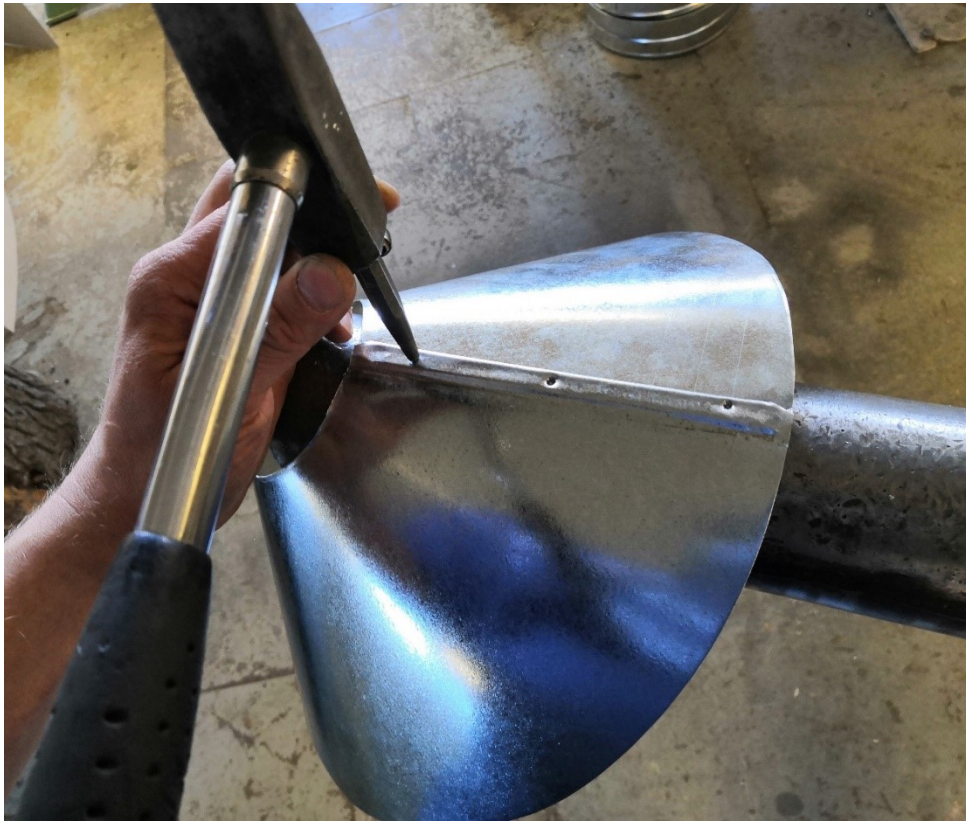
Kuva 205. Sauma lukitaan pistepuikolla ja vasaralla.
