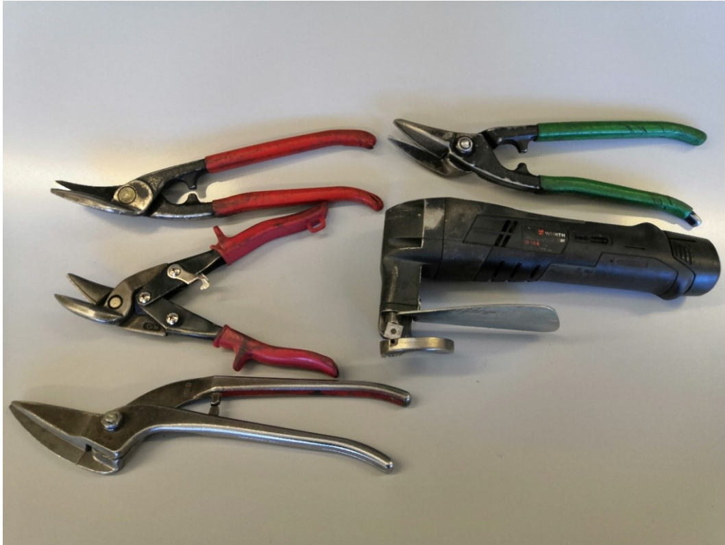
Kuva 27. Pellinleikkaamiseen tarkoitettua välineistöä. Ylärivissä oikean- ja vasenkätiset peltisakset, keskirivissä nivelletyt peltisakset ja akkukäyttöinen peltileikkuri. Alimpana pelikaanisakset, joiden avulla voidaan leikata suoria linjoja nopeasti.
