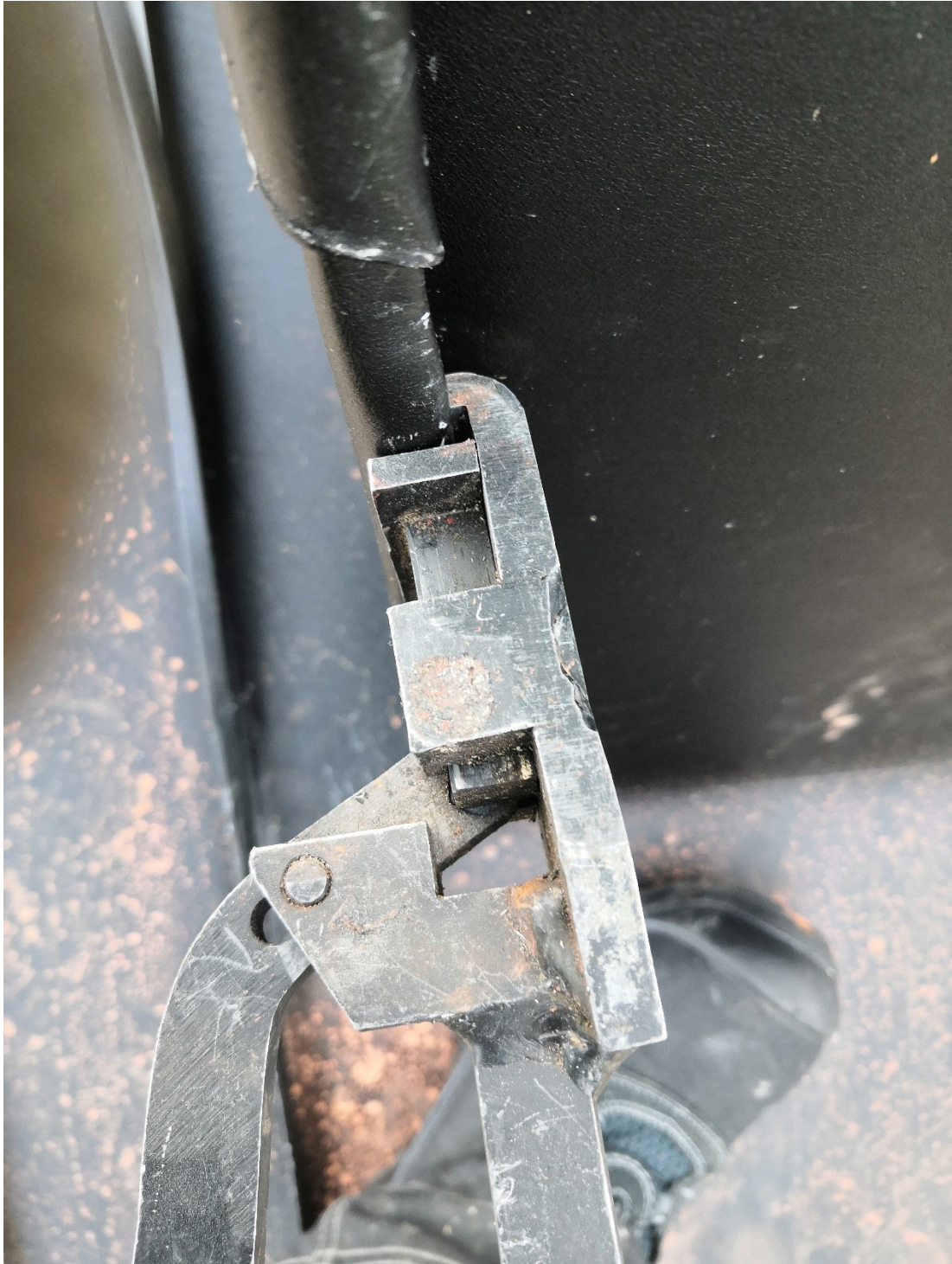
Kuva 29. Tuplasaumapihdit on muotoiltu siten että niiden leukojen puristusvoima on suuri. Kuvassa sauman kääntöä tuplaan. Tuplasaumapihtien kitasyvyys on mitoitettu tuplasaumaa varten.
