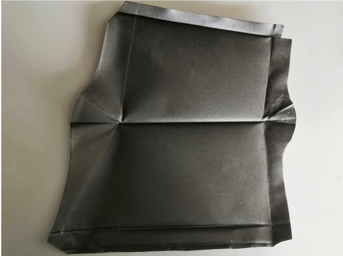
Kuva 15. Kanttauksen jäljet jäävät näkyviin suoristettuun peltilevyyn.
