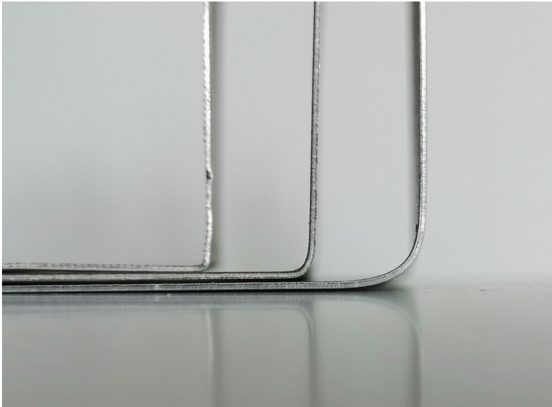
Kuva 69. Eri taivutussäteitä ( r ). Vasemmalla lähes materiaalin paksuuden mukainen r (liian pieni), keskellä kanttikoneen mukainen r , ja oikealla kattopihdeillä syntynyt r . Kuvan peltien vahvuus 0,6 mm.
