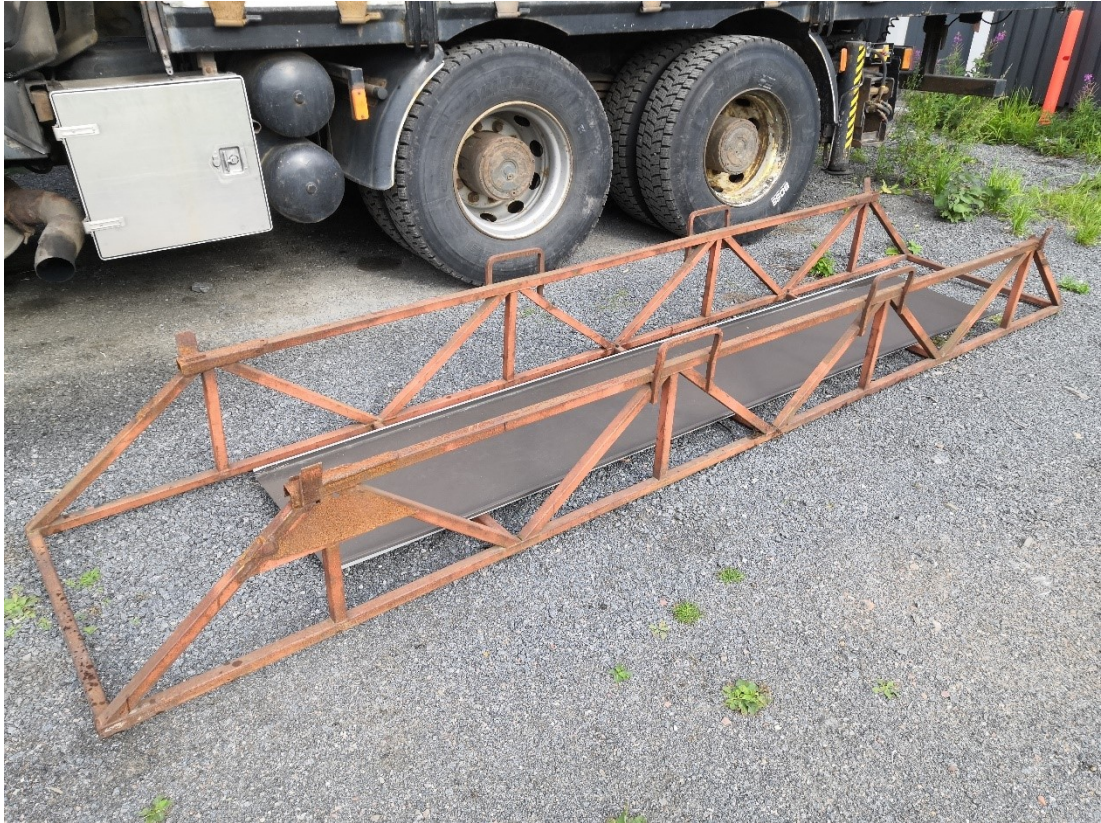
Kuva 109. Nostokehikko, jonka avulla katolle voidaan nostaa turvallisesti suurempikin määrä peltiä kerrallaan.
