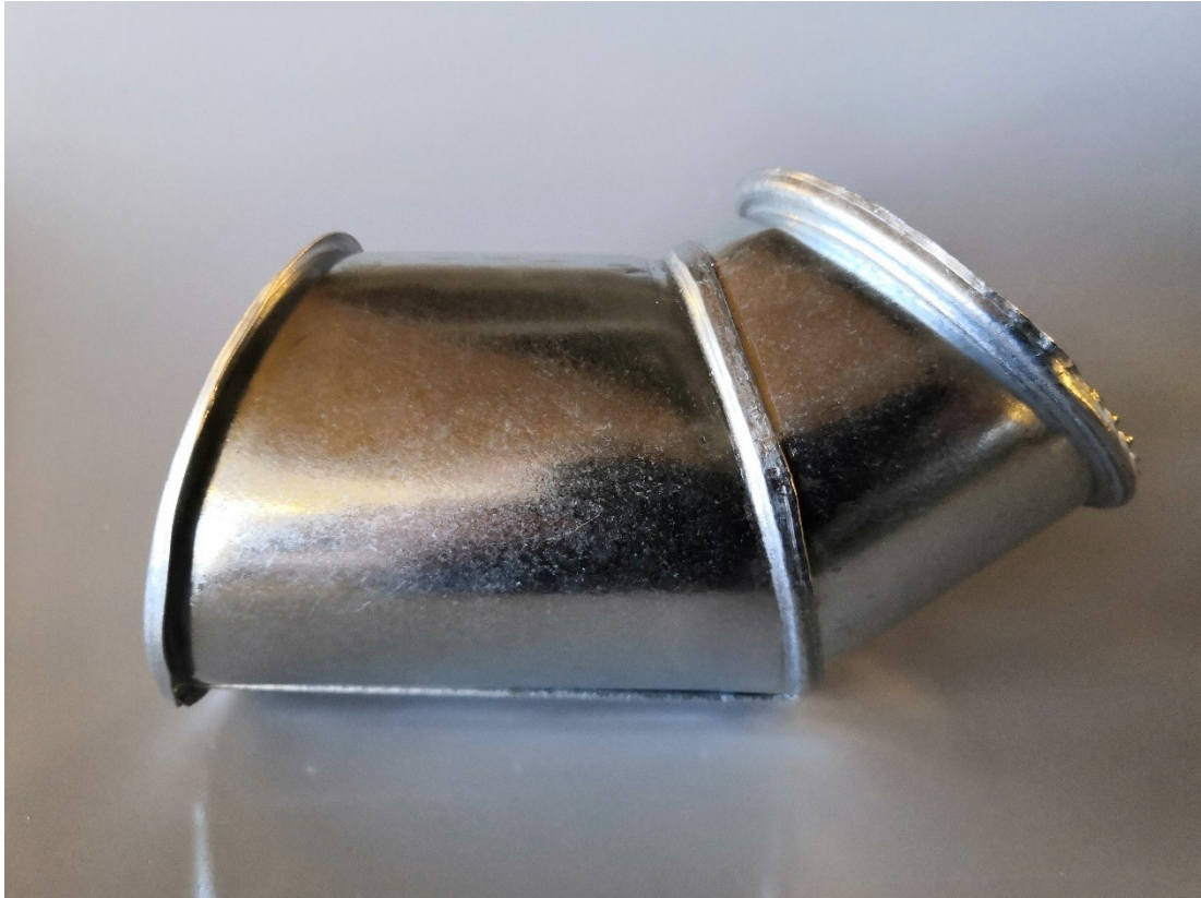
Kuva 211. Lähikuva valmiin sauman lopullisesta muodosta.
