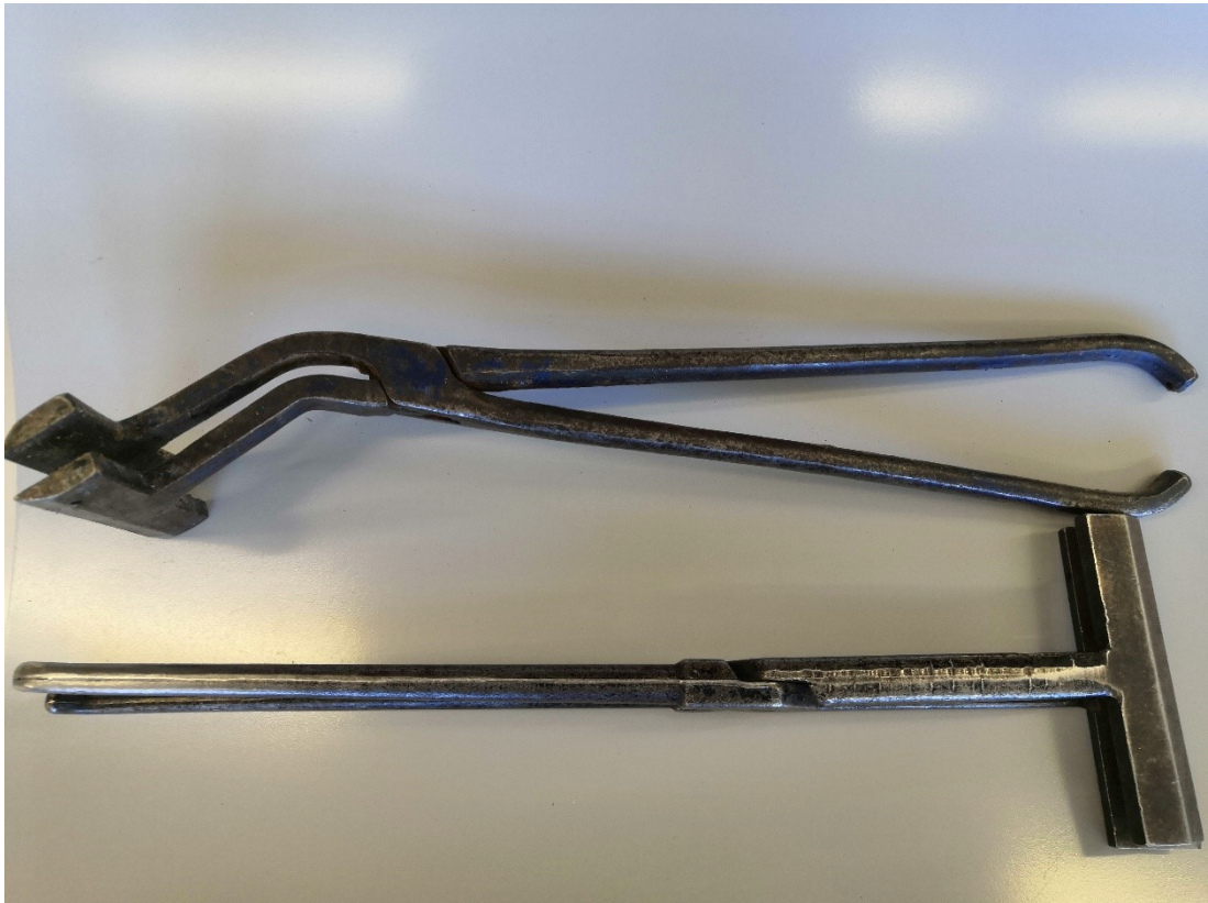
Kuva 26. Kattopihtejä saa kanttipihtien tapaan eri kulmilla. Kuvassa ylhäällä kulmassa olevat. Alhaalla suorat. Pihtien leukaosan leveys n. 160 mm.
