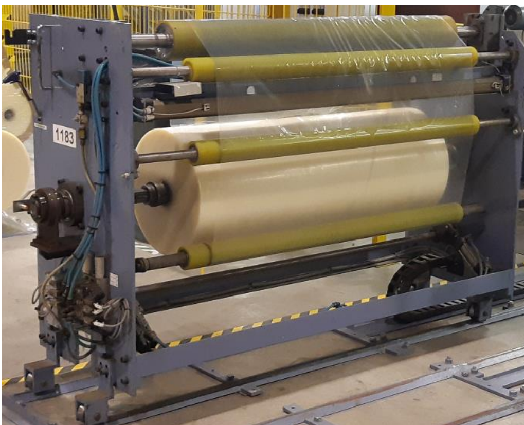
KUVA 4. Alapuolen suojakalvotuslaitteisto vedettynä sivuun
