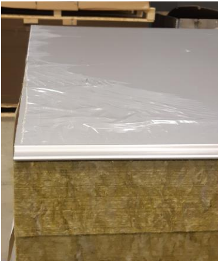
KUVA 10. Elementin päästä vetäytynyt suojakalvo
