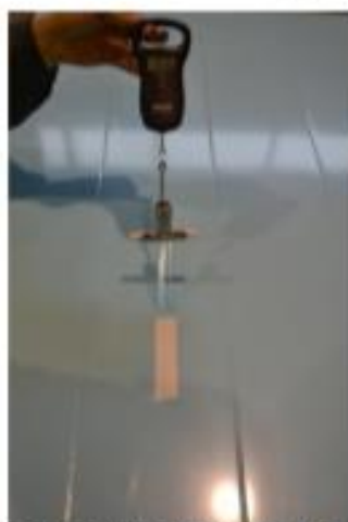
Kuva 4. Suojakalvon tartuntalujuuden testaaminen.
