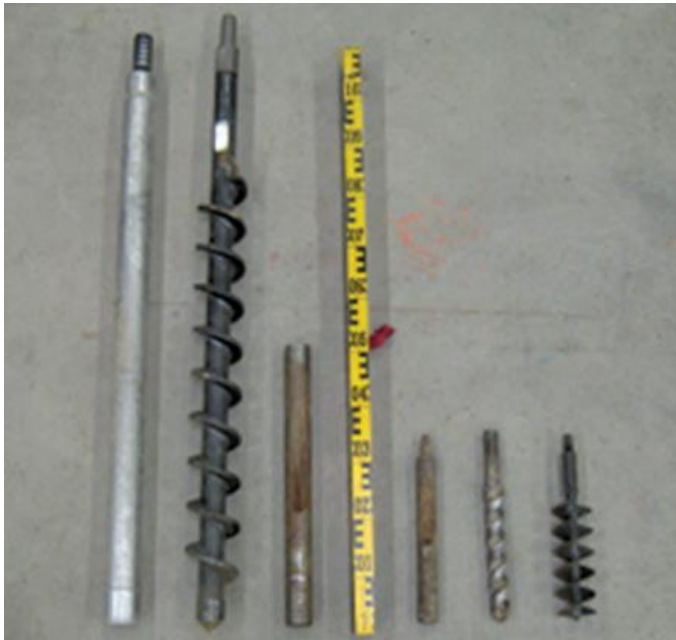
Kuva 6. Erilaisia kairoja. Mitta-asteikon vasemmalla puolella porakoneen kairan päät ja oikealla puolella on käsikäyttöiset kairan päät [2, s. 36].
