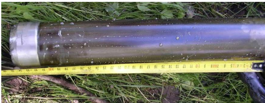
Kuva 12. Pilaantunut sedimentti [25, s. 12.]
