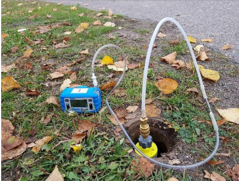
Kuva 17. Huokoskaasunäytteenotossa käytettävä pumppu ja korkki. [33, s. 3.]
