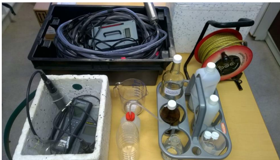
Kuva 14. Vesinäytteenottoon tarvittavia välineitä. Kylmälaukussa on vesinäytteenoton kenttämittarit. Mustassa laatikossa on akkukäyttöinen pumppu ja letku. Pöydällä on erilaisia näytteenottopulloja ja vedenpinnan korkeusmitta. [28, s. 3.]
