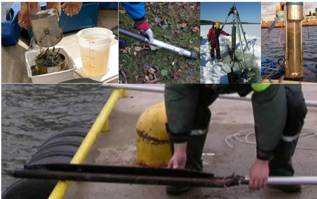
Kuva 13. Erilaisia sedimenttinäytteenottimia. Ylhäällä vasemmalta oikealle: kauhanäytteenotin, putkinäytteenotin, Kullenberg-mäntäkaira ja limnos-näytteenotin. Alhaalla on laippakaira. [25, s. 35–48.]
