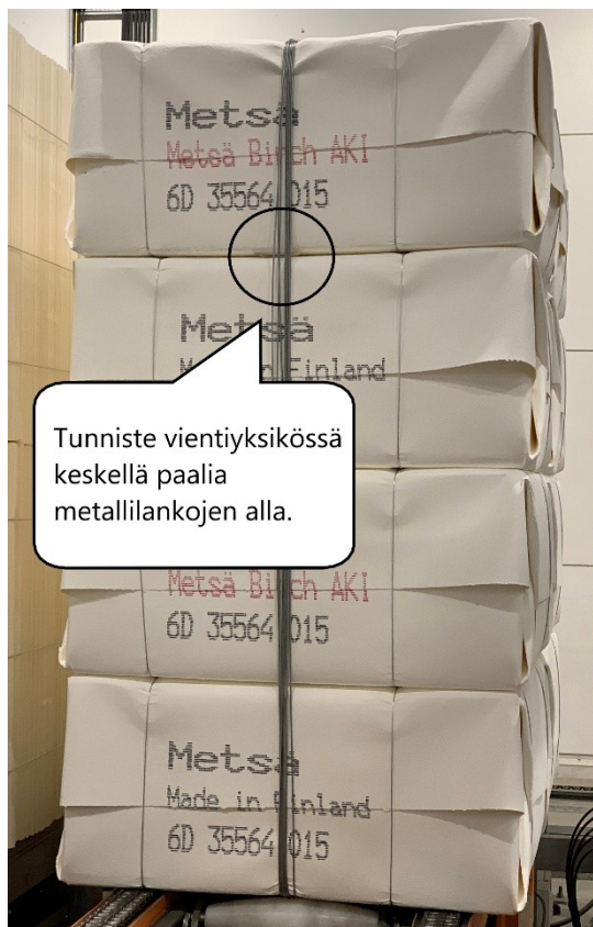
Kuvio 37. Rejektipaali, jossa tunniste metallilankojen alla
