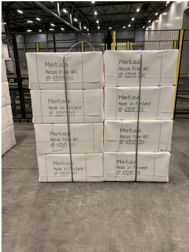
Kuvio 38. Vasemman puoleisessa paalissa katkennut vientilanka
