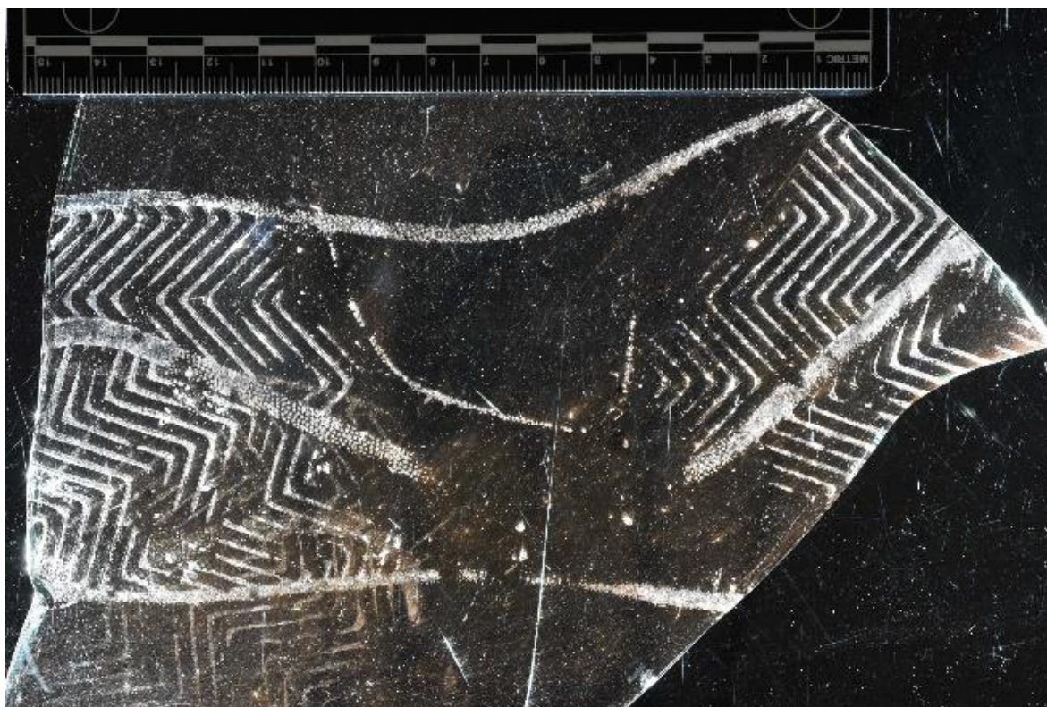
Bild 1: Fotografi av skoavtryck som är upplyft med hjälp av klisterfolie. Källa: Ålands polismyndighet, 2019.
