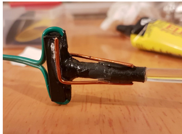
Ledin pohjassa on pieni jäähtyssiili, sillä se lämpenee hieman. Valokuitu on kiinnitetty lediin kutistesukalla, pikaliimalla sekä nestemäisellä sähköteipillä. Koko rakenne on tuettu kuparilangoista tehdyllä tukirakenteella.
