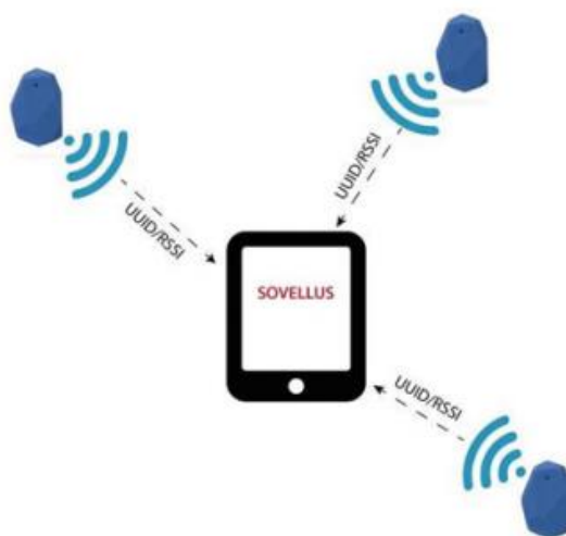
KUVA 4. Paikantaminen Bluetooth-lähettimek perusteella (Peltola & Toivanen 2017, 9)
