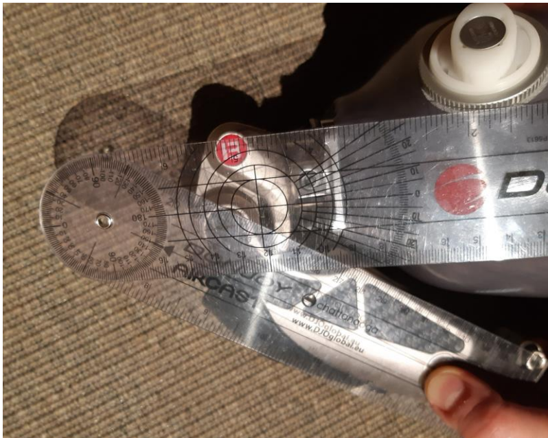
Kuvio 21. Testiproteesin vapaa liikerata ylsi 145 asteen koukistukseen ilman polvikomponenttia. Mittaukseen käytettiin goniometriä. (Kuva: Suvi-Anna Korhonen 2020.)
