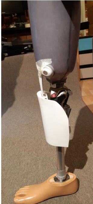
Kuvio 20. Polvikomponenttikokonaisuus kiinnitettynä testiproteesiin. Kiinnitys suoritettiin ruuveilla ja maalarinteipin ja hakaneulojen avulla. (Kuva: Suvi-Anna Korhonen 2020.)
