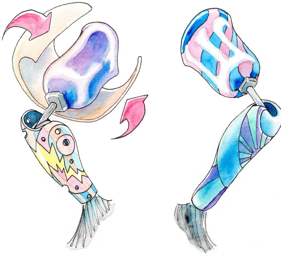
Kuvio 3. Esimerkkejä 3D-tulostetuista kosmeettisista vaihtoehdoista reisiproteesiin. Vasemmalla koristeellinen, 3D-tulostettu, teräväreunaisempi säärkosmetiikka, johon voidaan yhdistää reisiholkin ylle rakennettava kosmeettinen kuori cambolitesta. Oikealla koristeellinen, 3D-tulostettu, reunoiltaan pyöristetyn säärkosmetiikka, joka on yhdistetty kuvioituun reisiholkkiin. (Kuvat: Suvi-Anna Korhonen 2020.)
