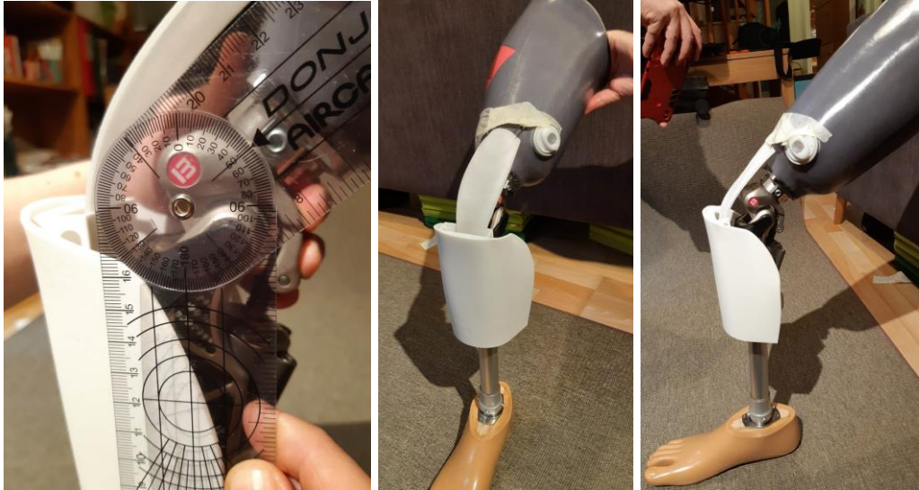
Kuvio 22. Testiproteesin koukistuskulman mittaus polvikomponentin kanssa (vas.) sekä maksimaalinen koukistuminen kauempaa katsottuna (Kuva: Suvi-Anna Korhonen 2020).
