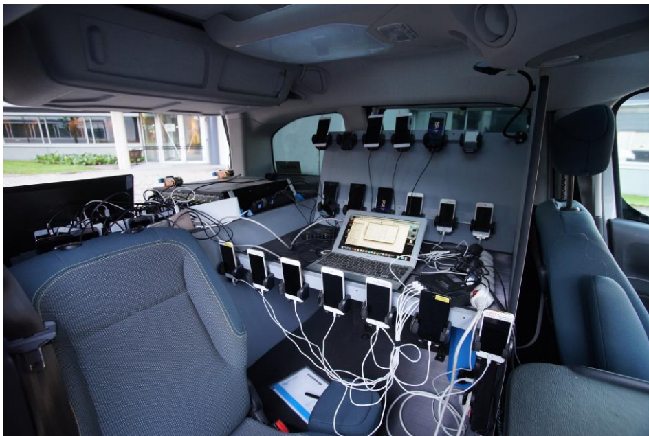
Kuva 22. Usealla matkaviestinlaitteella testaus testiauton takatilassa.
