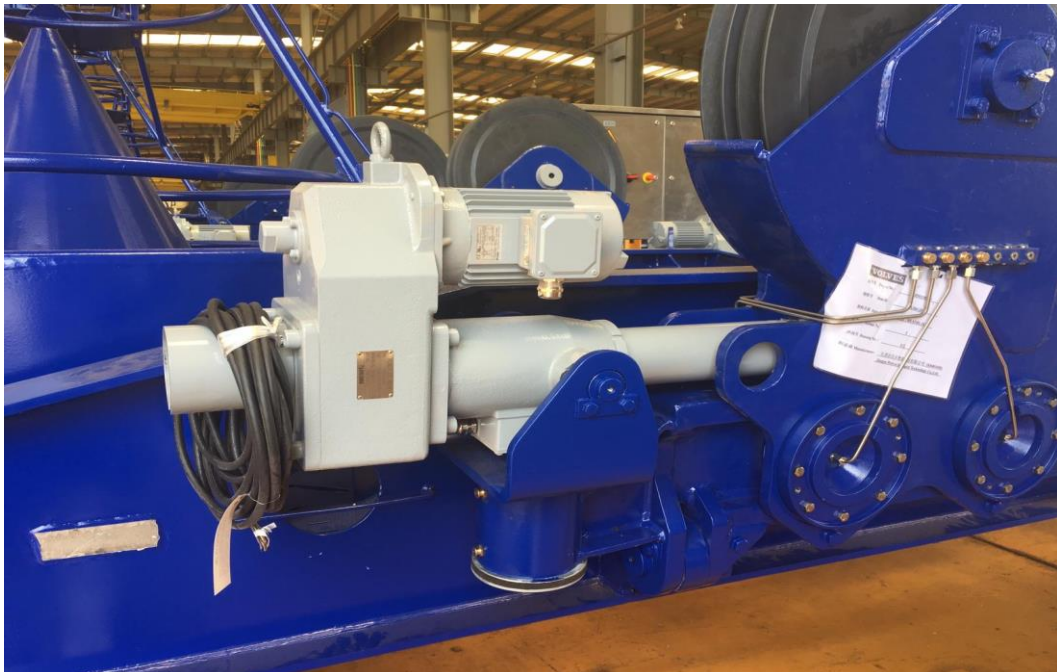
Kuva 3. Tsubaki-sylinteri asennettuna Kalmar headblock:iin.
