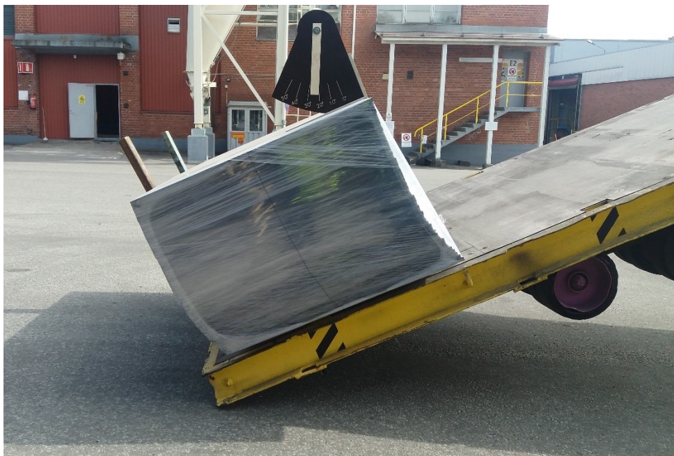
Kuva 7. Leveyden suuntaan kallistus pinnoitetulla vanerilla (Ritonen, T. 2020)
