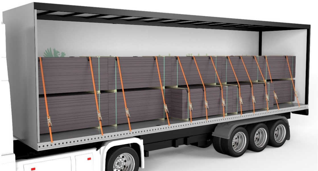
Kuva 4. Kuorman yli sidonta (Roulamo, 2020)
