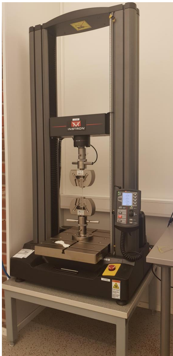
Kuva 11. Vetolaite vetoleukoineen. Vetoleuat oli suunniteltu kestäämään 50 kN:n voimia. Laitteessa oleva näyttölaite näyttää siihen ohjelmoituja arvoja reaaliajassa ajon aikana.
