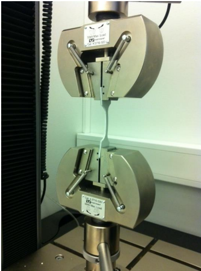
Kuva 13. Näytekappaleen kiinnitys vetokouriin oikeaoppisesti. Olennaista kiinnityksessä oli silmämääräinen tarkastus, että näytteen reunat olivat tasassa vetokourien kanssa ja näytekappaleen kiinnityskohdat olivat yhtä paljon vetokourien sisällä.
