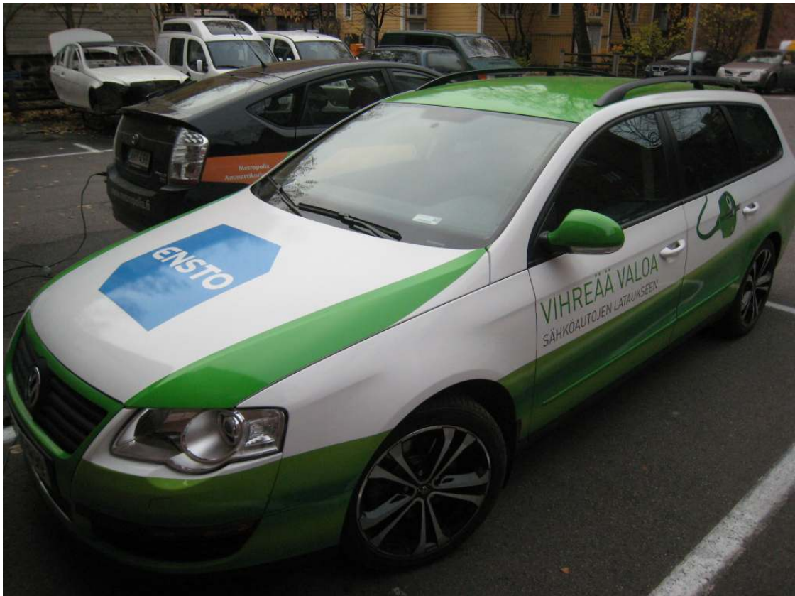
Kuva 1. Toinen testijakson ajoneuvoista, Enston muunnossähköauto.
