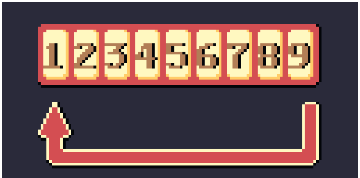
Kuva 11. Visualisaatio rengaspuskurista, jossa voidaan säilyttää yhdeksän arvoa samanaikaisesti.
