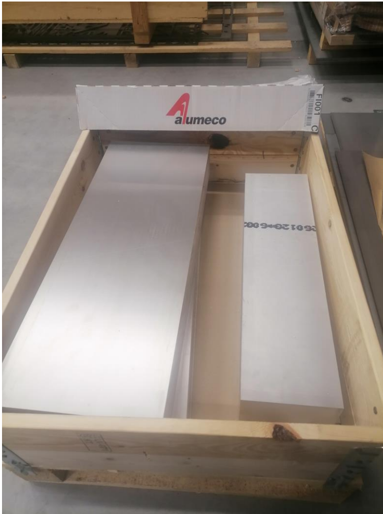
Kuva 26. Imusarjakokoonpanon alumiinaihiot, jossa vasemmalla kokoojakammioiden puolikkaat ja oikealla ensiöputken laipparunko.
