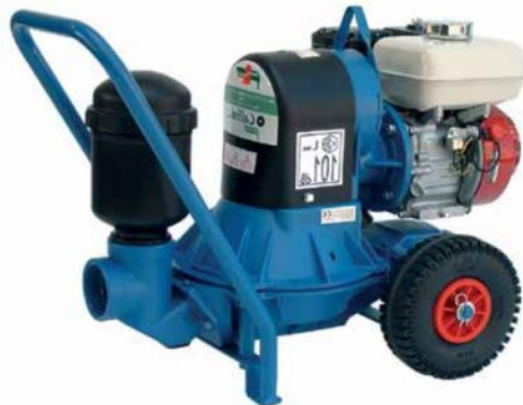
Kuva 18 Caffini Libellula -pumppu varustettuna polttomoottorilla ja kuljetuspyörillä (Caffinipumps).
