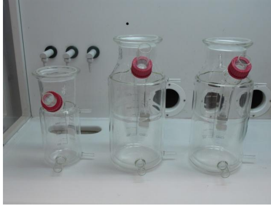
KUVA 17 Vasemmalla 1 litran reaktori ja keskellä sekä oikealla 4 litran reaktorit. Reaktoreihin on kiinnitetty syöttöputket tiivisteineen.
