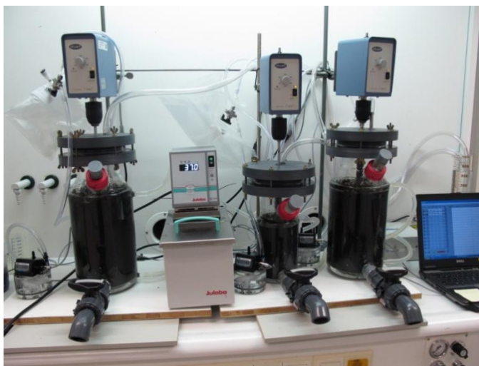
KUVA 16 Vasemmalla referenssireaktori, keskellä 1., vaiheen reaktori ja oikealla 2. vaiheen reaktori. Referenssireaktorin ja 1. vaiheen reaktorin välissä on vesihäide. Reaktoreiden vasemmalta puolella ovat kaasumittarit ja oikeassa takakulmassa on varolinjan vastapainevesi mittalasia. Jokaiseen reaktoriin on kytketty kaasupussit kolmitiehaaralla kaasunpoistolinjaan.
