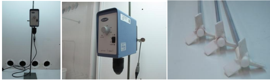
KUVA 19 Vasen ja keskimmäinen kuva ovat sekoittimesta ja oikeanpuoleinen kuva käytetyistä sekoitinpäistä
