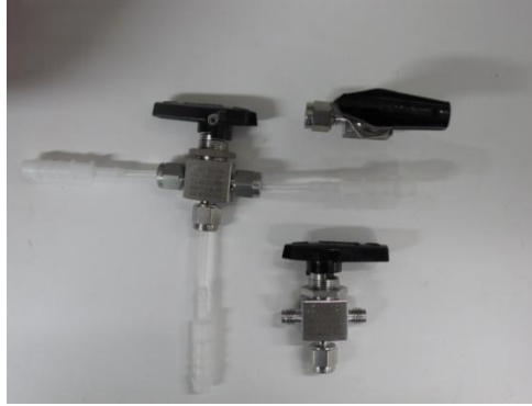
KUVA 22 Swagelok (3mm) kolmitiehaarat, joihin liitetty teflonputkea (3mm) sekä alhaalta tulevaan ja vasemmalle jatkuvaan linjaan liitinpala (4/8).
