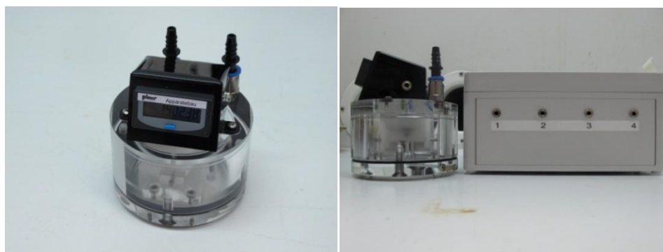
KUVA 21 Vasemalla milligascounter MGC-1 kaasukenno sekä LCD näyttö. Oikealla Milligascounteer MGC-1 kaasukenno sekä digitaalinen ulostulomoduuli (4 sisääntulokytkentää)
