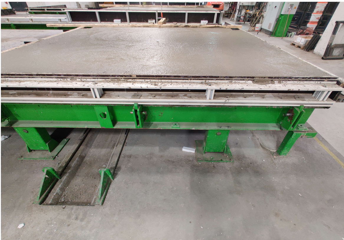
Figur 9. Ett färdigt gjutet och slipat element som är klart för härdning (Jansson, 2020).
