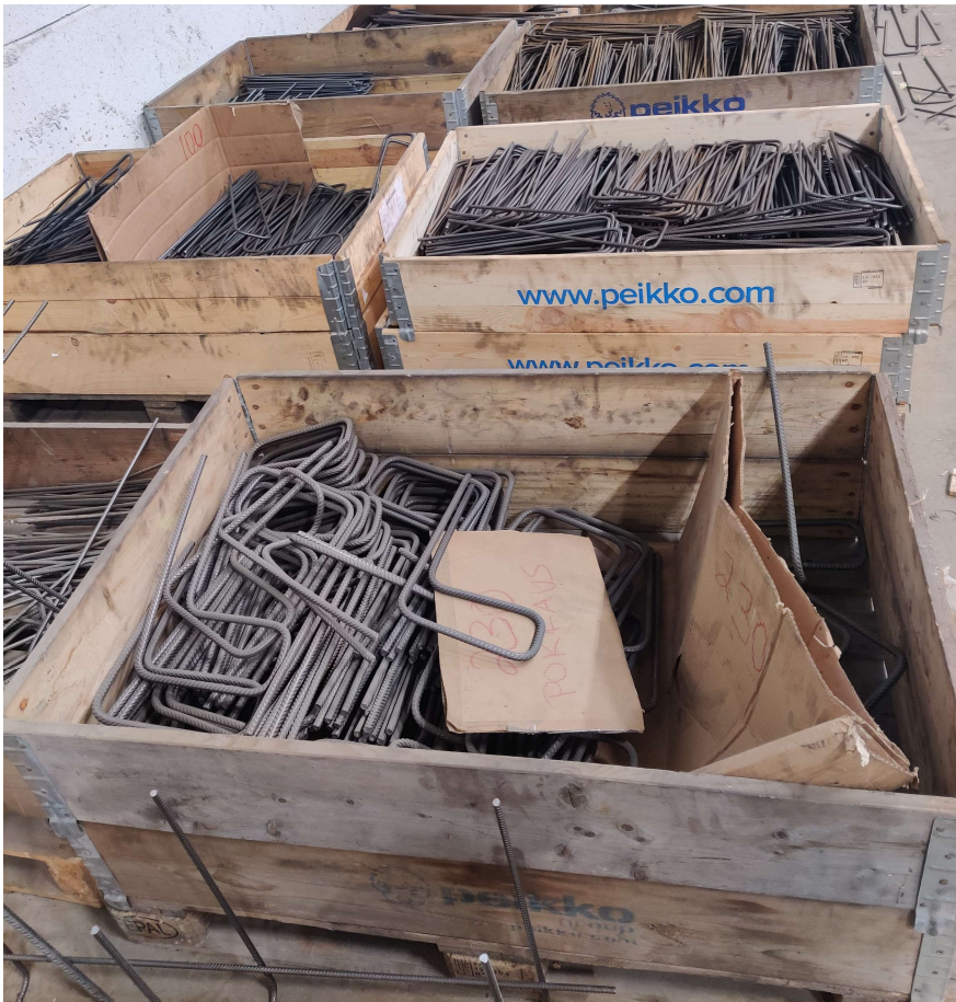
Figur 7. Olika typer av c-länkar för armerandet. Namnet c-länk kommer från att armeringsstålet är bockat 90 grader två gånger (Jansson, 2020).
