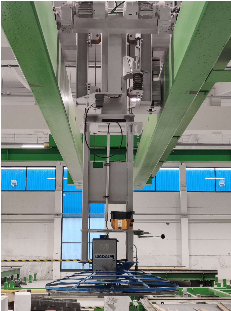
Figur 10. Med hjälp av denna maskin kan man enkelt och smidigt slipa elementen trådlöst till en slät och jämn yta. Maskinen fungerar så att den går att flytta framåt, bakåt, vänster och höger. För att kunna slipa elementet går maskinen även upp och ner för olika tjocklekar av element. Längst ner på maskinen ligger en platta som snurrar och på så vis jämnar och slätar ut ytan på elementet (Jansson, 2020).
