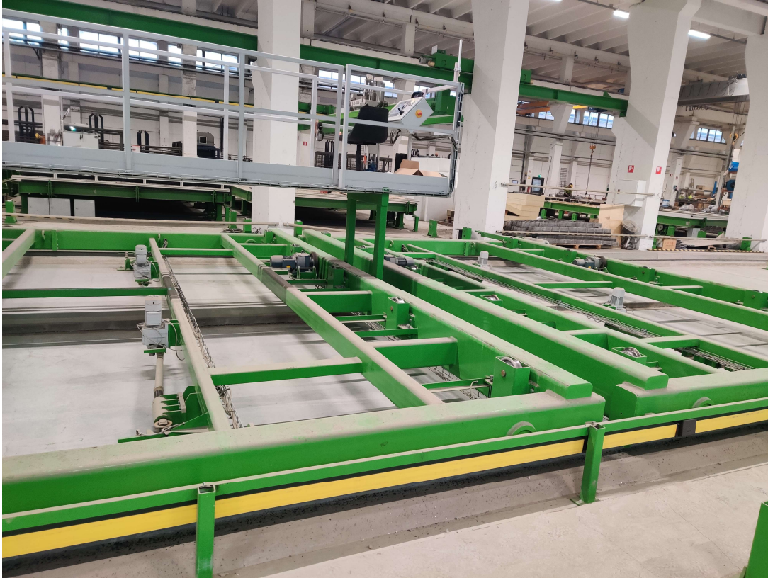
Figur 13. På detta sätt flyttas modulerna via sektionerna. Maskinen rör sig på två skenor och med hjälp av elmotorer rör den sig från ena sidan till den andra. På samma vis rör sig modulen in och ut. Det finns plats för två moduler åt gången (Jansson, 2020).
