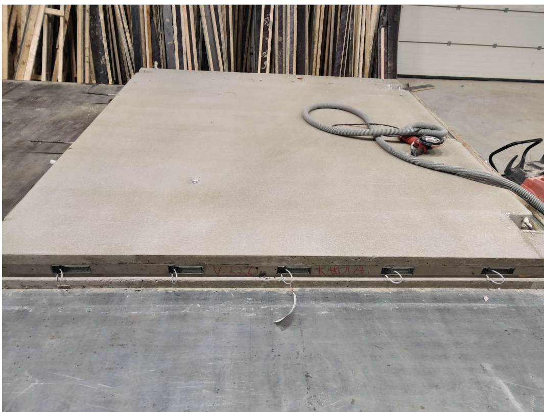
Figur 11. Färdigställandet av ett prefabricerat element. Här har man slipat ytan för att göra den jämn. Vajerlänkarna är utdragna och på en av vajrarna har man placerat en lapp där elementets specifikationer finns. På lappen anges tillverkaren, elementets mått, vikt, och tillverkningsdatum (Jansson, 2020).
