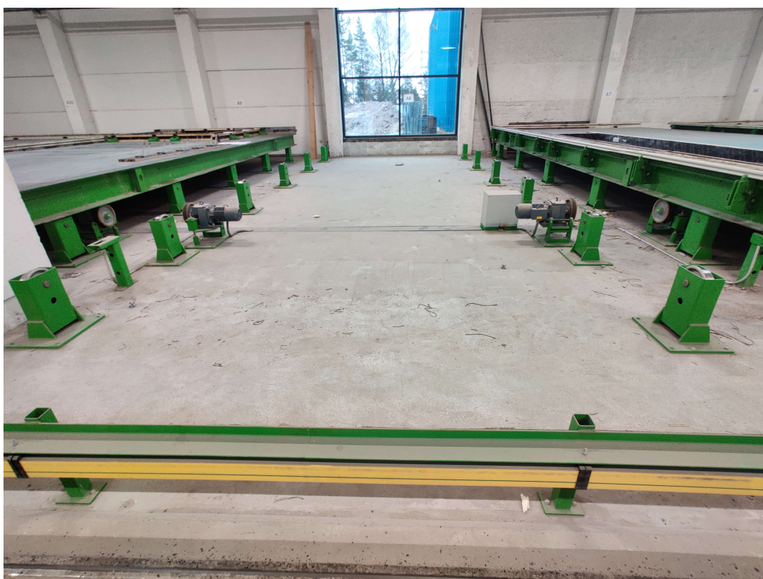
Figur 12. Bilden visar hur det ser ut innan en modul har placerats. Själva modulen hålls upp med hjälp av fötterna och elmotorerna gör så att modulen kan köras på plats (Jansson, 2020).
