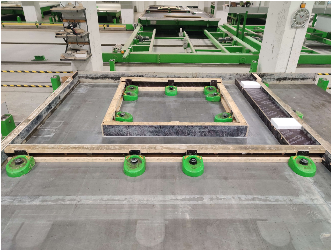
Figur 1. En färdig form som är redo att byta sektion (Jansson, 2020).
