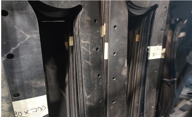
Kuva 18. Merkityt vesilaatikoiden tiivistekumit.
