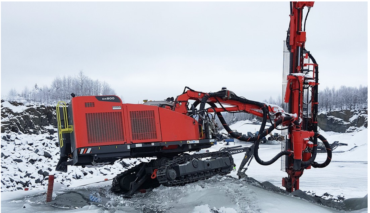
KUVA 1. Sandvik Ranger dx800 keskiraskas poravaunu (5)
