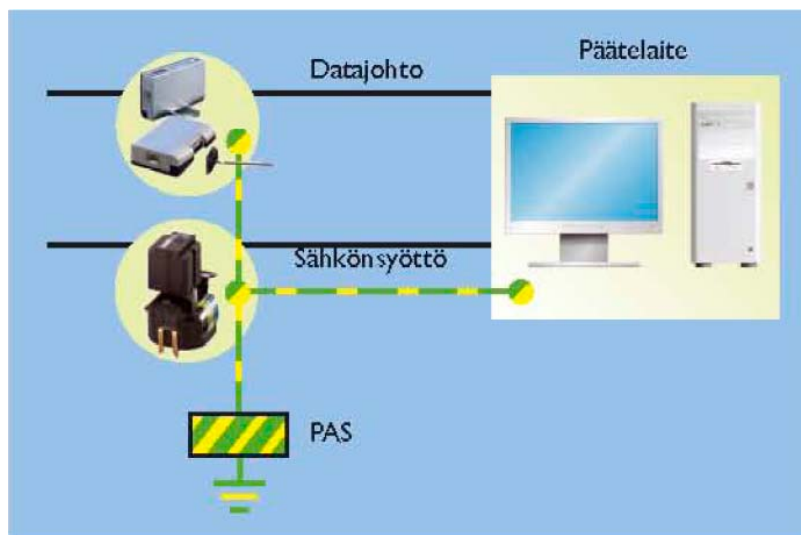
Kuva 3.13 Esimerkki dataliitäntöjen kojesuojauksen toteutuksesta (2, s. 19).
