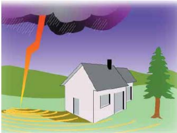
Kuva 2.1 Maapotentiaalin suureneminen (4, s. 1).
