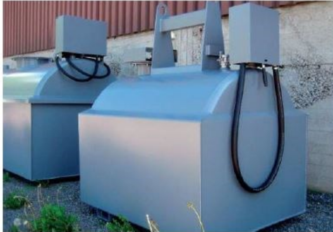
Kuva 8. Varastointiin ja kuljetukseen hyväksyty IBC-pakkaus, jossa nostosanka ja käsipumppu.
