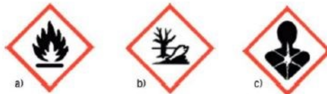
Kuva 10. Varastosäiliön varoitusmerkit. Symbolit kuvaavat kevyen polttoöljyn vaaraominaisuuksia: palava neste (kuva a), ympäristölle vaarallinen (kuva b) ja terveydelle vaarallinen (kuva c)
