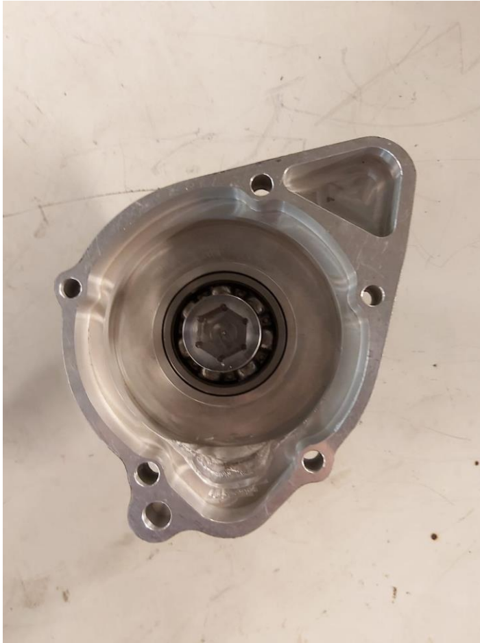
Kuva 20 Moottorin sivuposki sisäpuolelta kuvattuna
