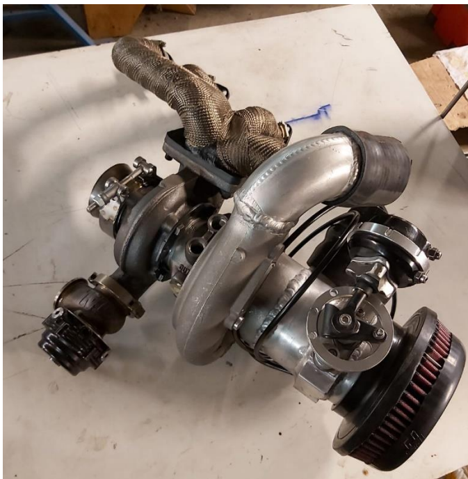
Kuva 14 Turboahdin muutosten jälkeen
