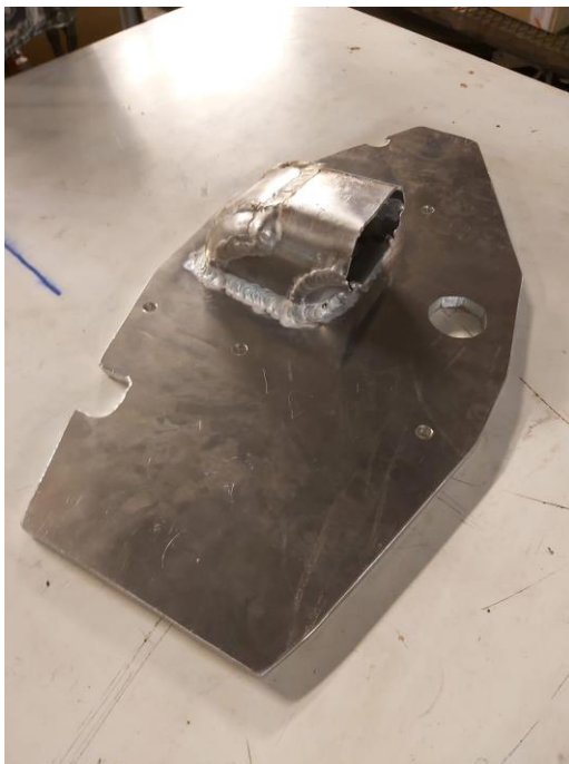
Kuva 15 Ahtimen kiinnikelevy ja painepuolen lähtö keskeneräisenä
