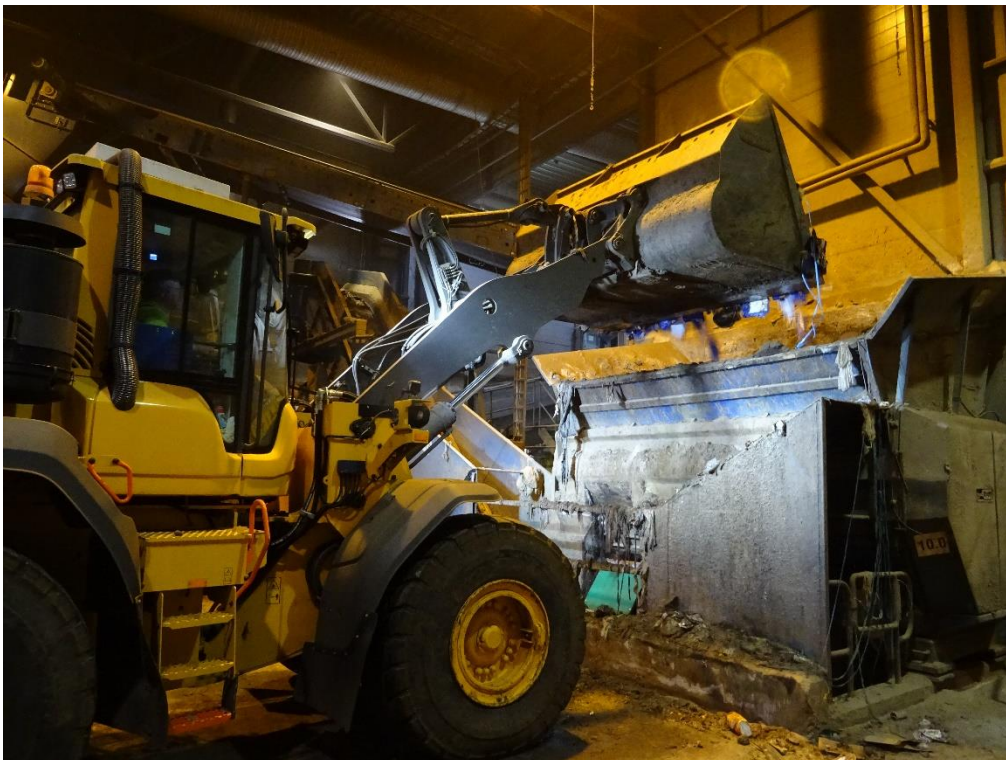
KUVA 9. Mashmasterin syöttäminen pyöräkuormaajalla (Labio Oy 2020).
