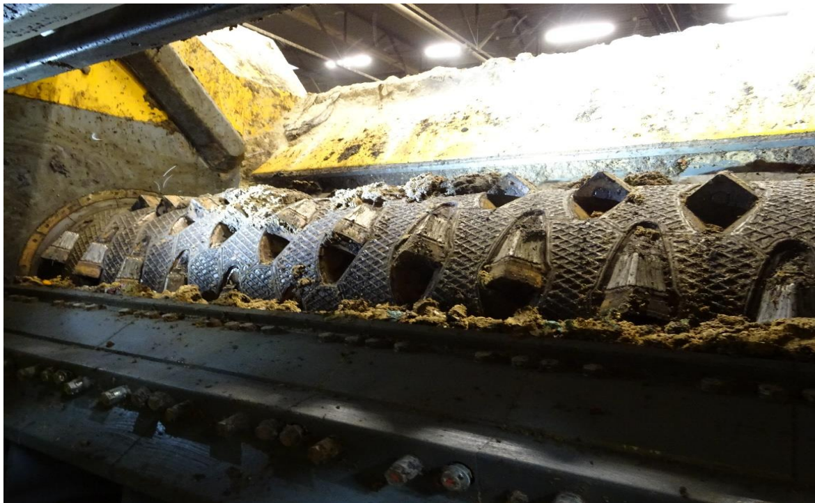
KUVA 11. Unthan roottori huoltoluukulta katsottuna (Sundholm 2020).
