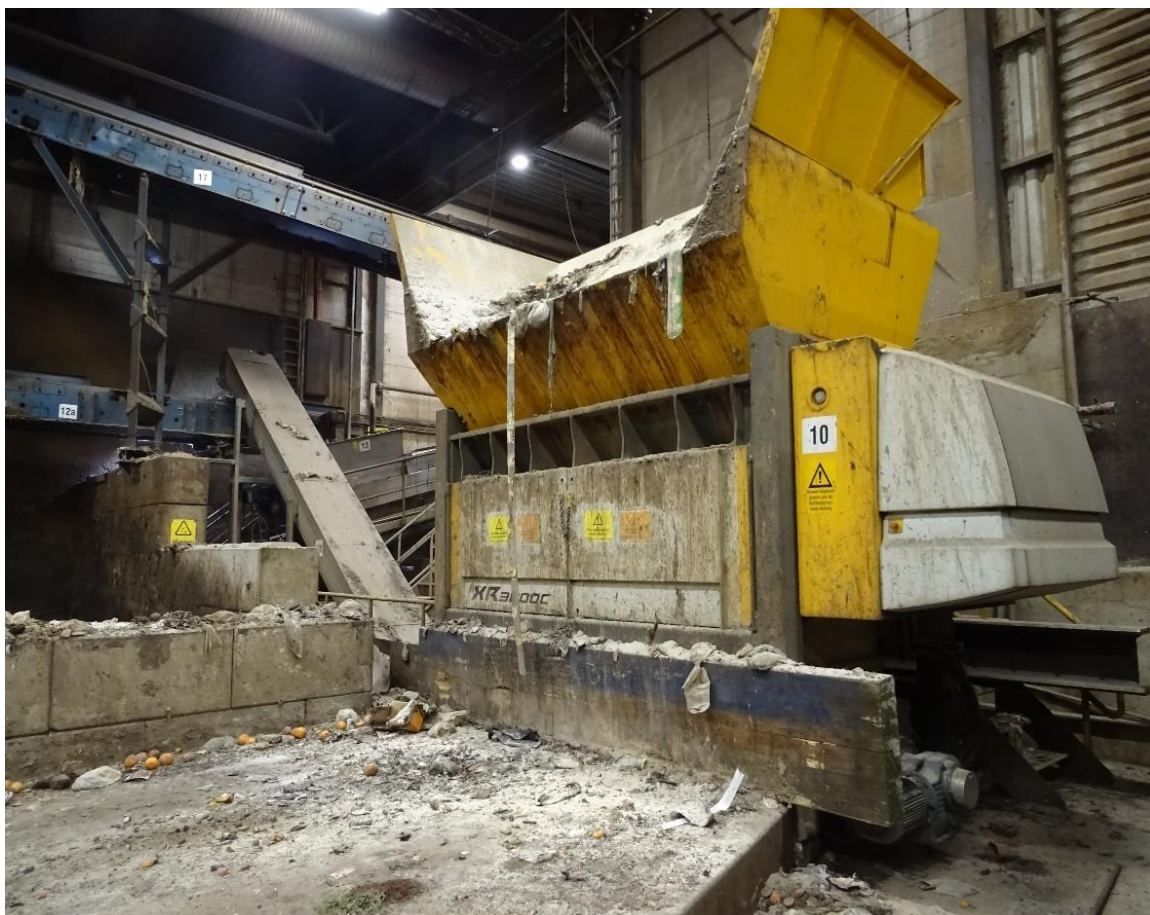
KUVA 13. Untha uudella suppilolla ja rampilla (Sundholm 2020).
