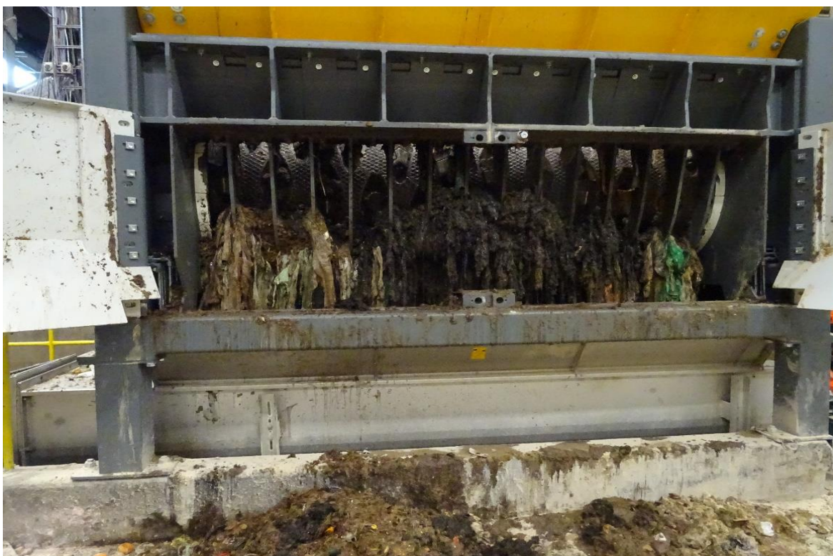
KUVA 12. Unthan sihtitangot ovat keränneet muovia (Sundholm 2020).
