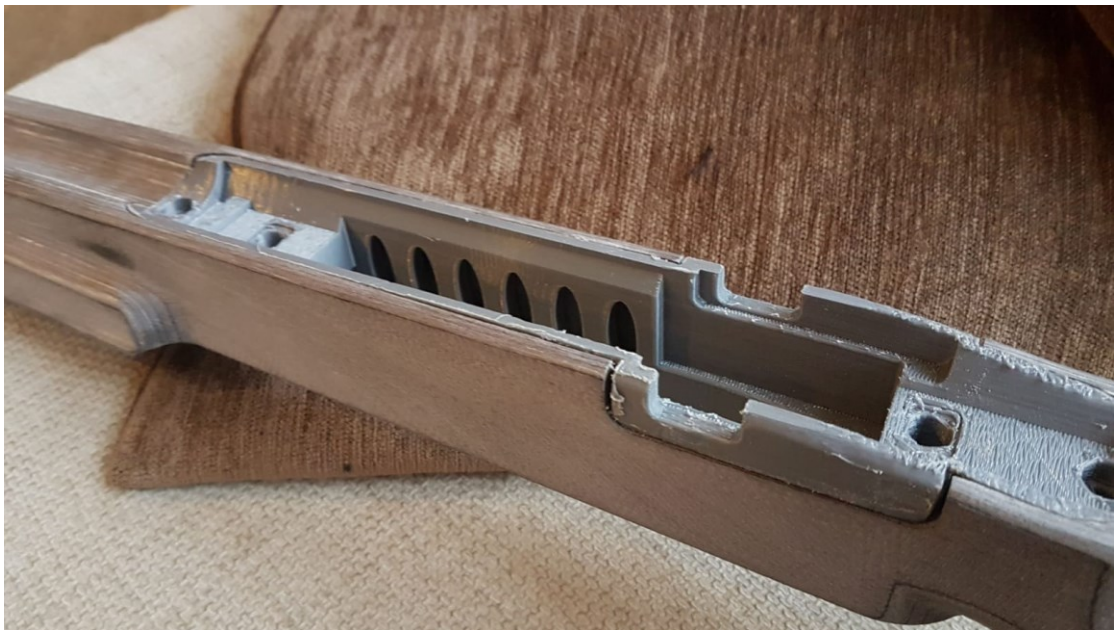
Kuva 12: Sovite paikoillaan tukin sisällä. Kevennykset muutettiin ellipseiksi sillä ne voitiin tulostaa ilman erillisiä tukirakenteita.
