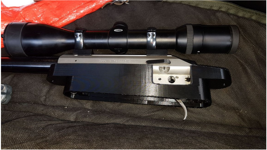
Kuva 8: Valmis tuloste kiinnitettyä kiväärin lukkorunkoon.
