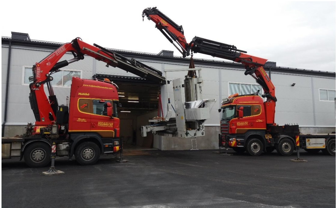
Kuvio 6. Nosto ja Kuljetus Ruuska Oy:n henkilökunta auttamassa raskaan työstökoneen siirtämisessä uuteen toimipisteeseen sisälle.
