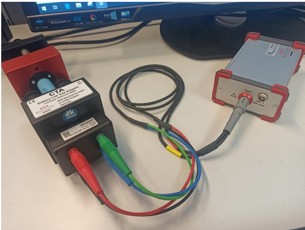
Kuva 12 BIM2-mittalaite ja jigii 18650-kennoille.
