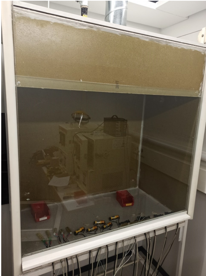
Kuva 14 Turvakaappi missä kennot olivat latauksen ja purun aikana.
