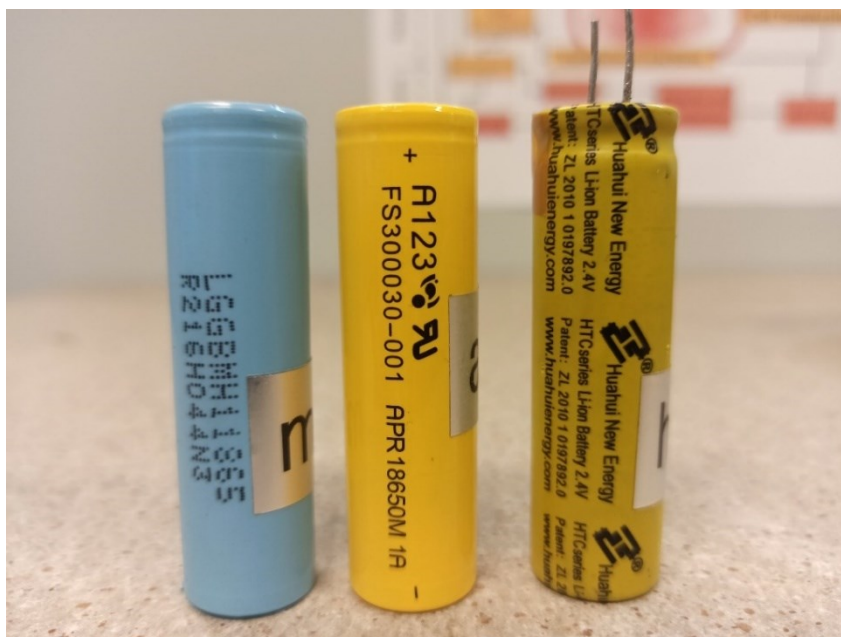
Kuva 7 MH1-, A123- ja HTC-kennot, vasemmalta lueteltuna.
