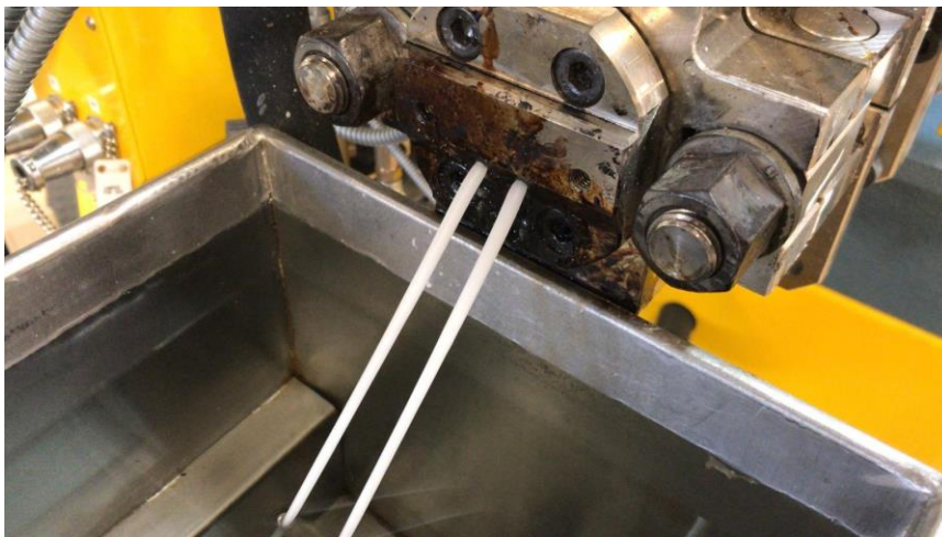
Kuva 4. Ekstruuderin suuttimen ulostuloaukot.
