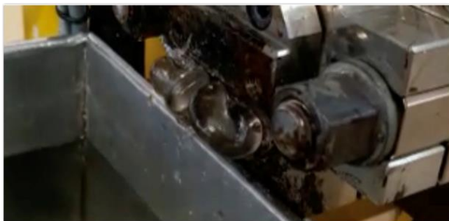
Kuva 23. Liian korkeat lämpötilat ja ajonopeudet aiheuttavat ongelmia, materiaali kasautuu suuttimen ulostuloaukolle.
