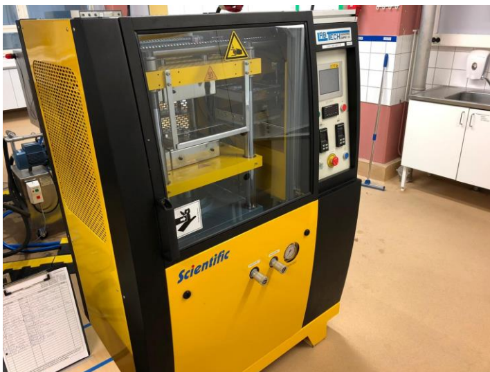
Kuva 8. Opinnäytetyössä käytetty hydraulinen puristin. LabTech Engineering Company LTD, Model LP-S-2.
