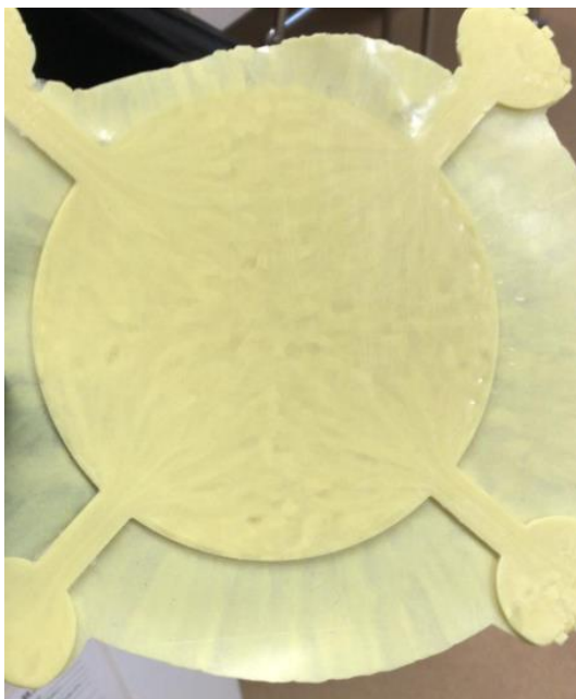
Kuva 35. EVA+Kevlar-seos puristuksen jälkeen. Ylimääräiset reunat on nopeaa ja helppoa leikata pois.
