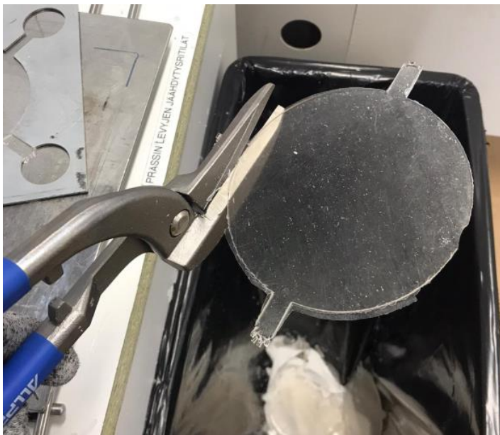
Kuva 37. Puristetuista PMMA-levyistä leikattiin varovasti peltisaksia käyttäen suurimmat ylijäämät pois. Saksien kanssa täytyi olla varovainen, koska liian raju käsittely saattoi johtaa koko levyn lohkeamiseen.
