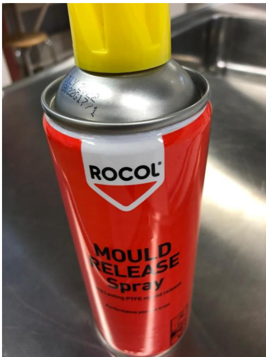
Kuva 14. Työssä käytetty muotin irroitussuihke puristuksen helpottamiseksi
