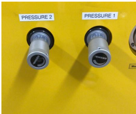
Kuva 11. Hydraulisen puristimen puristusvoiman eli paineiden säätökahvat.
