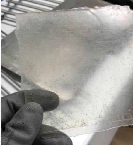
Kuva 26. PMMA IG840 puristettu optimaalisilla lämpötiloilla.
