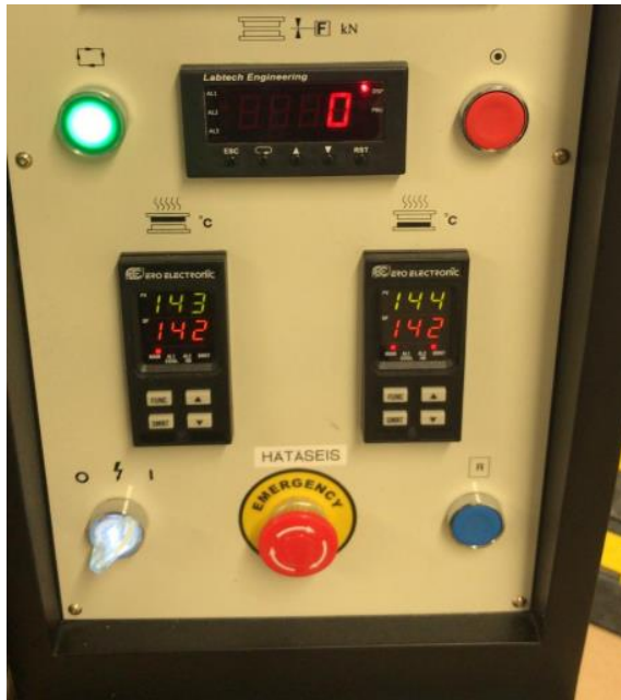
Kuva 9. Hydraulisen puristimen lämpöelementtien ohjauspaneeli.
