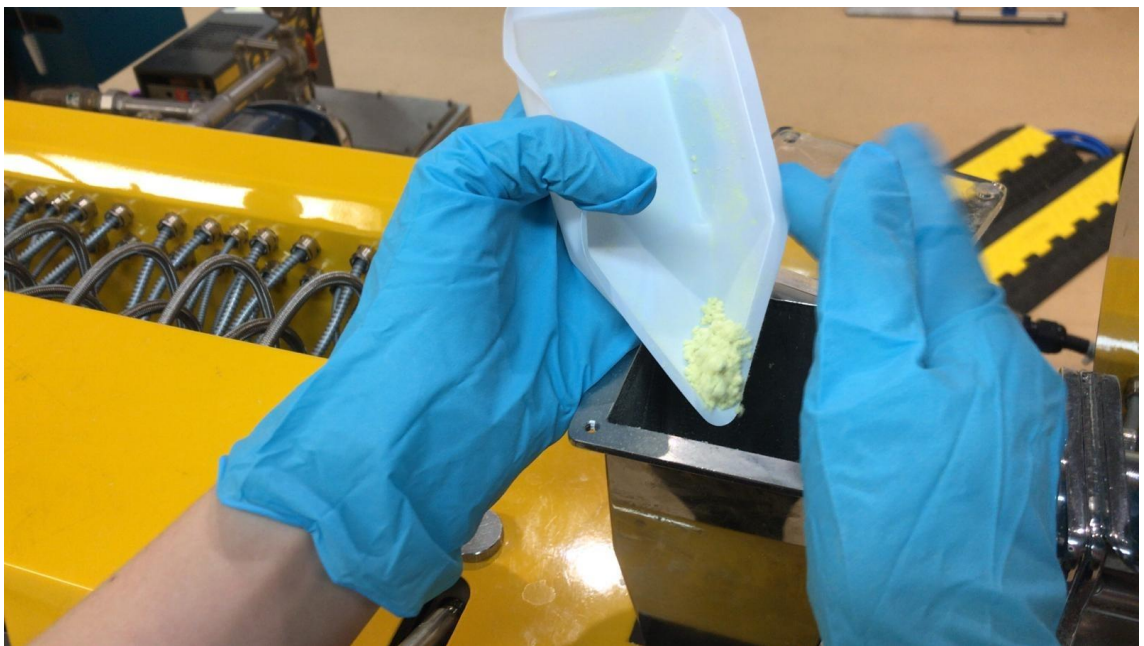
Kuva 20. Kuitulujitteiden syöttö tapahtui käsin kuvan osoittamalla tavalla.
