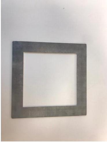
Kuva 12. EVA+lasikuituseoksissa käytetty puristusmuotti.
