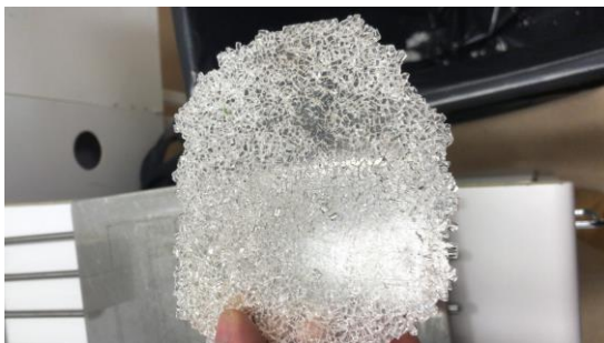
Kuva 25. PMMA IG840 puristettu liian matalilla lämpötiloilla.
