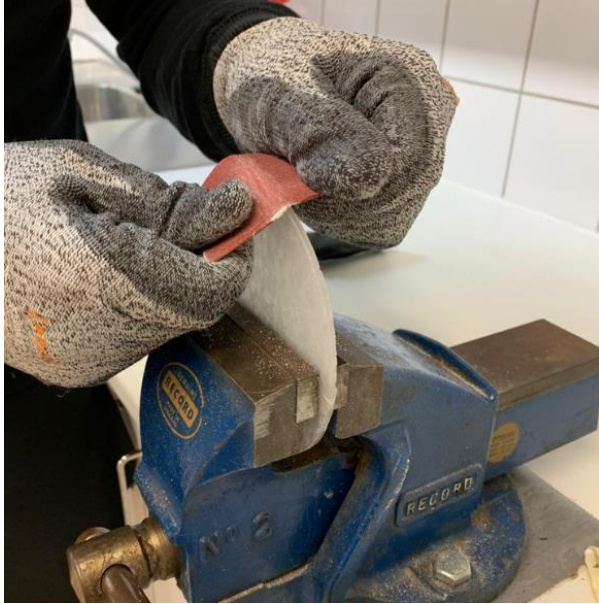
Kuva 38. Karheat reunat hiottiin sileäksi PMMA-levyistä.
