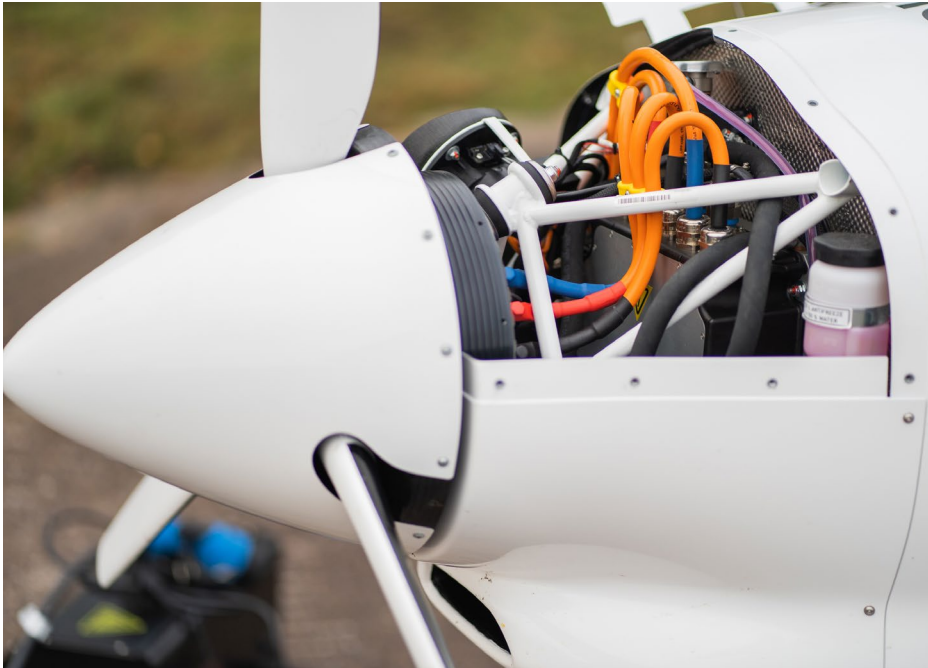
Kuva 2. Pipistrel Alpha Electro -sähkölentokoneen moottoritila. (Kuva: Tomi Oravasari, 2020)
