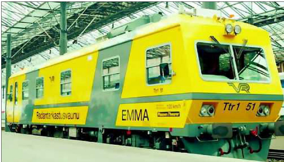
Figure 11. Emma inspection wagon. (Kaleva, 2003)
