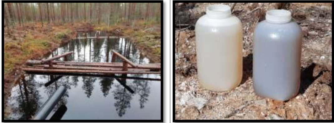
Kuvio 11. Puukasettirakenteet sekä vesinäytteet tulevasta (oikeanpuoleinen astia) ja lähtevästä vedestä (vasemmanpuoleinen astia).
