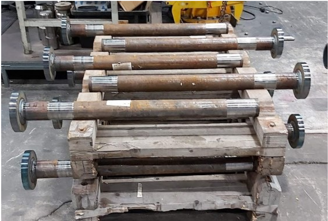
Kuva 7. Akseli robotti hitsauksen jälkeen.
