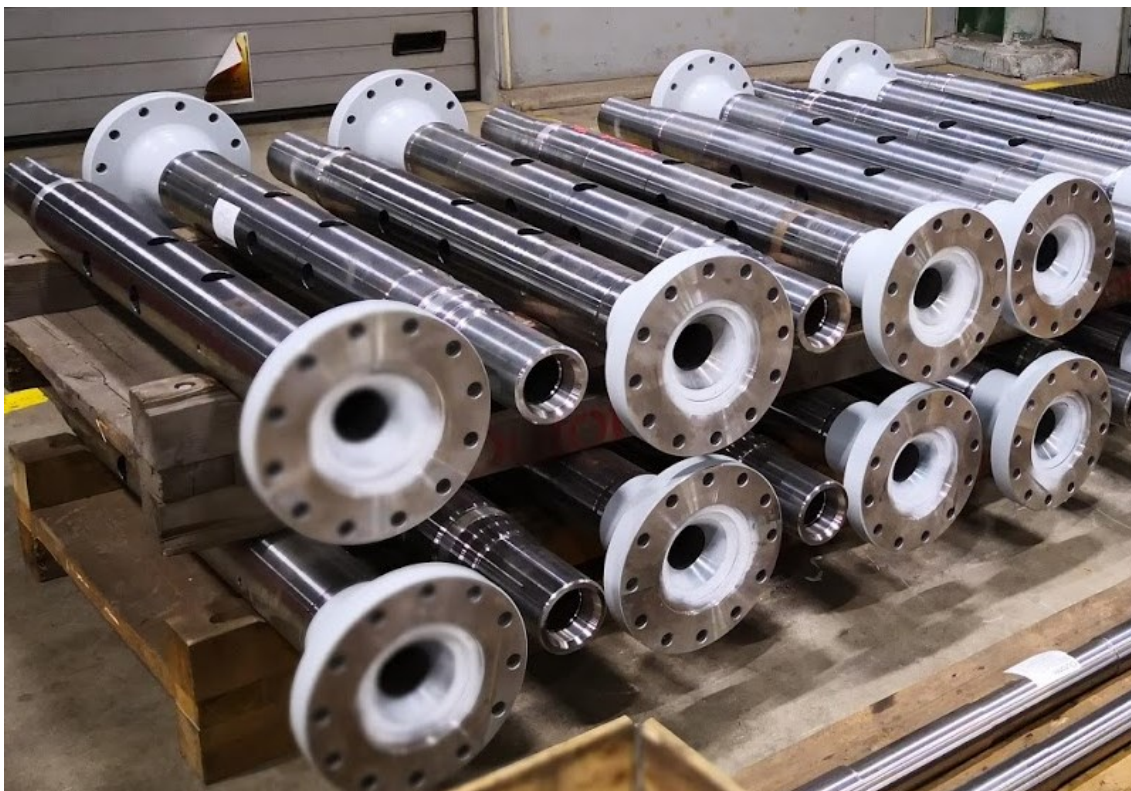
Kuva 3. Laakerointiyksiköiden akselit kampalavalla.
