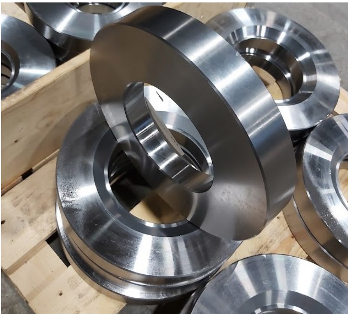
Kuva 5. Laakerointiyksikköjen laippojen esikoneistus.
