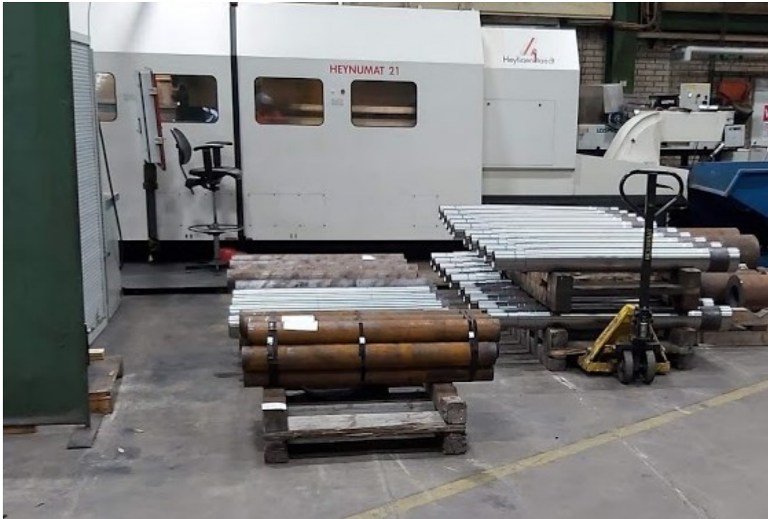
Kuva 6. Laakerointiyksikköjen akselin esikoneistus
