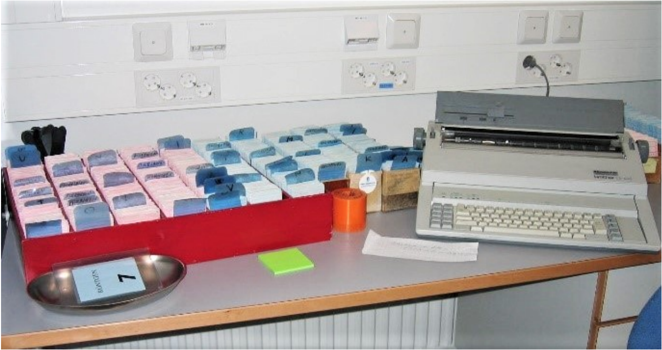
KUVA 3. Potilaskortisto analogiaikana. Korttiin kirjattiin tutkimus ja päivämäärä ja sen avulla leimattiin pimiössä potilaan nimi ja sosiaaliturvatunnus röntgenkuvaan. Nimikointilaitteessa oli valmiina tutkimuspaikka ja vaihdettava päivämäärä (kuva: Anja Henner)
