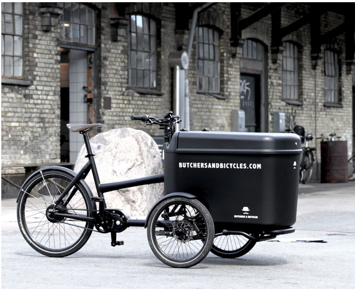
Kuva 2. Esimerkki kolmipyöräisestä rahtipyörästä (Munk 2016).
