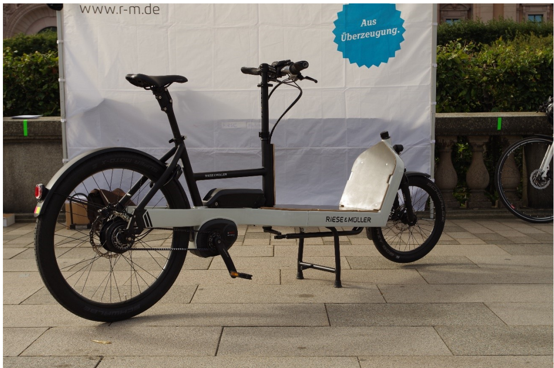
Kuva 1. Esimerkki kaksipyöräisestä Long John rahtipyörästä (Endoro 2016).
