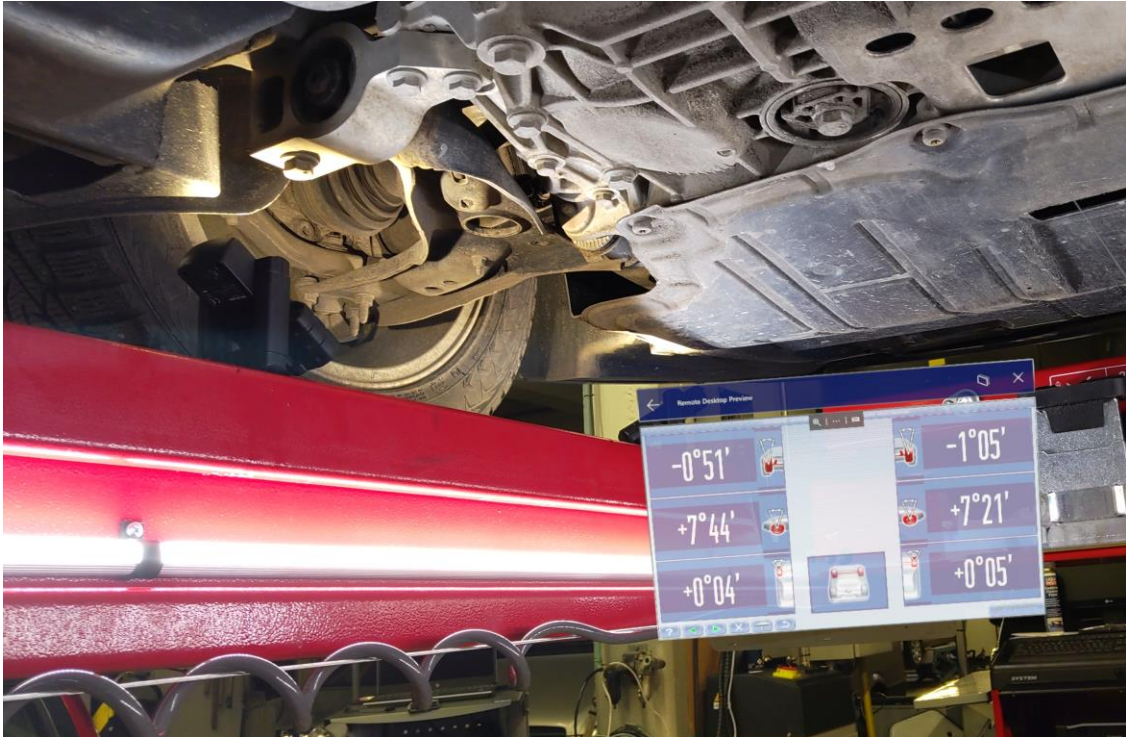
KUVIO 9. Microsoft HoloLens 2 XR-lasit käytössä auton 3D-pyöränsuuntauksessa (Jari Aitta)
