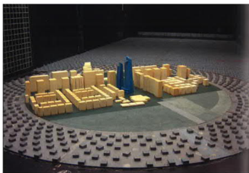
Kuva 6. Puhalluksessa olevien rakennusten pienoismalleja tuulitunnelikokeissa (FIB 2014, 82).
