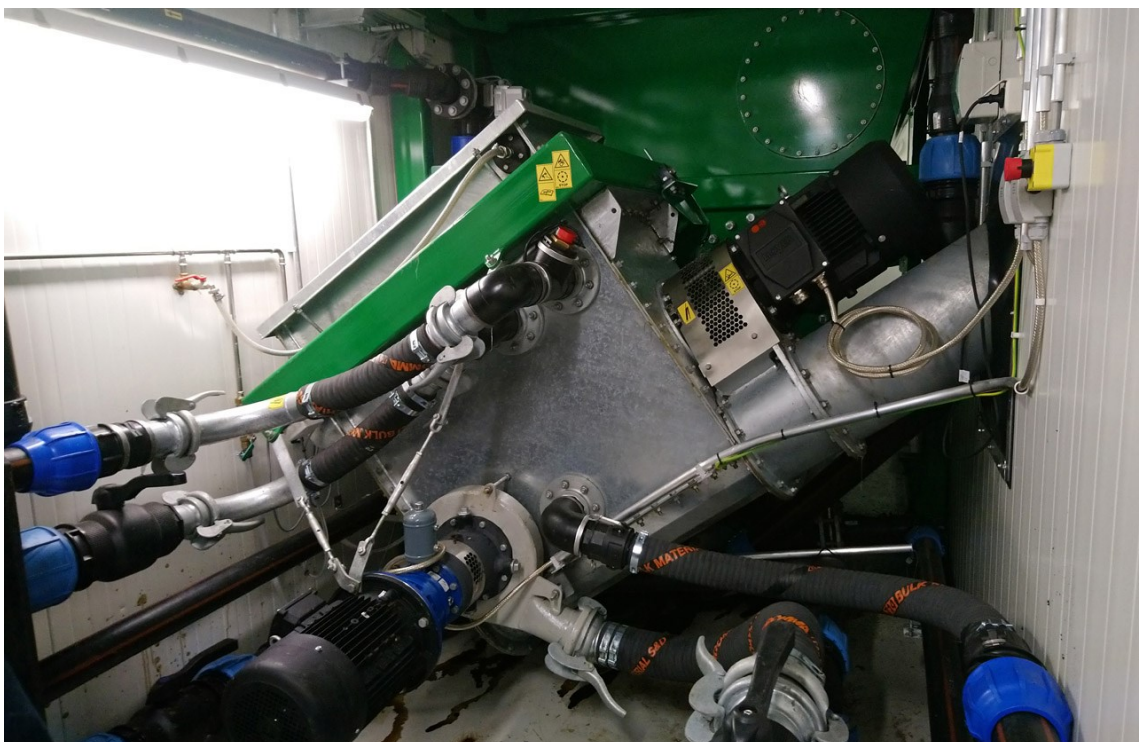
Kuva 6. Moderni biokaasulaitos vaatii monialaista insinööriosaamista. Kuvassa biomassan syöttölaitteistoa. Demeca, Toholampi, Tammikuu 2020 © Pekka Alho
