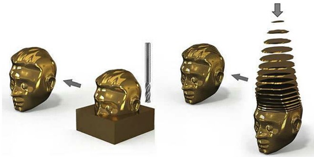
Kuva 1. Ainetta poistava ja ainetta lisäävä valmistustekniikka (Diegel ym. 2020, 2).
